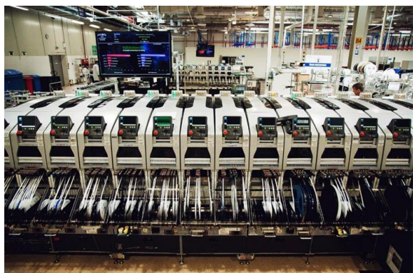
Рисунок 9. Линии поверхностного монтажа в цехе Jabil-Uzhgorod.
