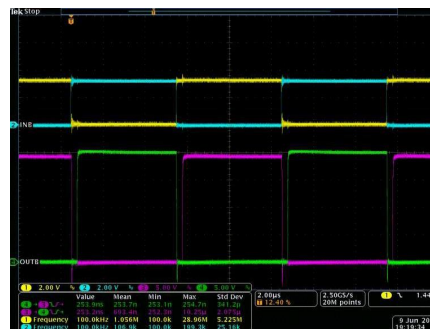
Осциллограммы сигналов на входах INA/B и выходах OUTA/B.
