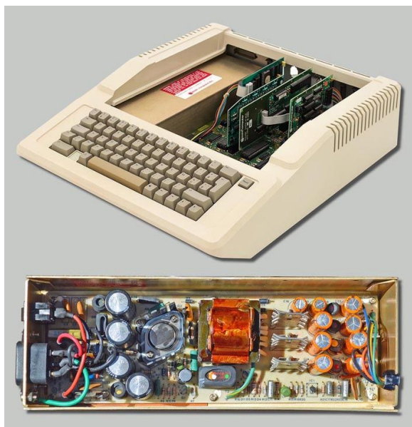
Рисунок 4. 38-ваттный многоканальный импульсный обратногоходовой источник питания компьютера Apple II, разработанный Родом Холтом.
