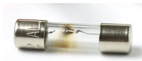
Рисунок 2. Состояние предохранителя 3AG в стеклянном корпусе легко проверить.
