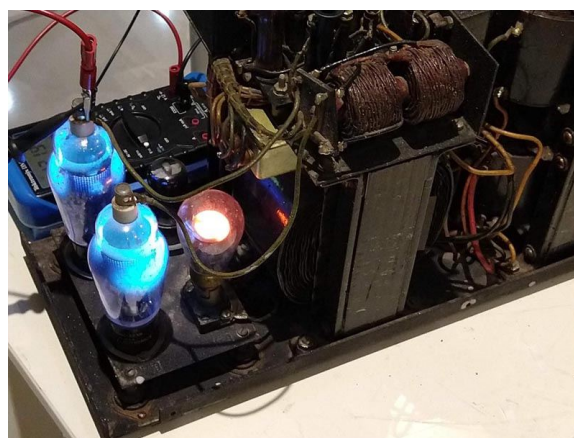
Рисунок 5. Вакуумные тиратроны в блоке питания REC-30 телетайпа светятся синим светом. Оранжевый свет – это неоновая лампа, используемая в качестве источника опорного напряжения. (Источник: http://www.righto.com ).
