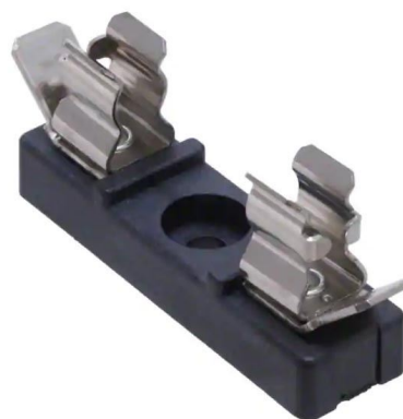
Рисунок 3. Этот держатель предохранителя привинчивается к монтажной поверхности, а провода присоединяются либо с помощью скользящих контактов, либо припаиваются.
