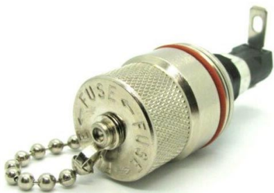
Рисунок 5. Для ответственных приложений выпускаются металлические держатели предохранителей 3AG, имеющие крышку, снабженную цепочкой, которая также образует единый с шасси экран, обеспечивающий защиту электромагнитных и радиочастотных помех.
