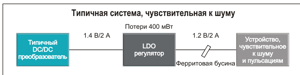
Рисунок 1. Типичная малошумящая архитектура, основанная на использовании DC/DC преобразователя, LDO регулятора и фильтра с ферритовой бусиной.
