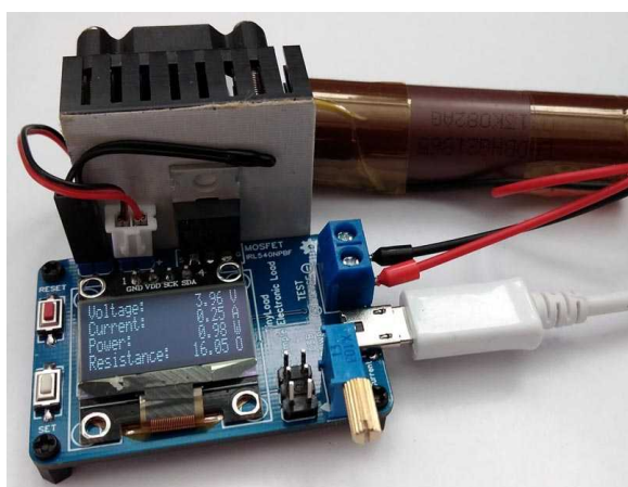
Рисунок 1. TinyLoad – электронная нагрузка с OLED дисплеем на микроконтроллере ATtiny45/85.
