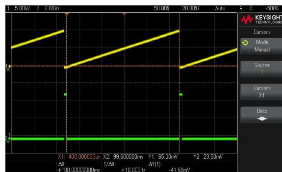
Рисунок 3. Осциллограммы сигналов в схеме: выход пилообразного напряжения (желтый), гасящий импульс (зеленый).
