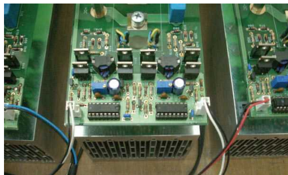
Рисунок 1. Этот изолированный импульсный драйвер может передавать сигналы с любыми коэффициентами заполнения даже при управлении мощными MOSFET/IGBT модулями с большой входной емкостью затвора.
