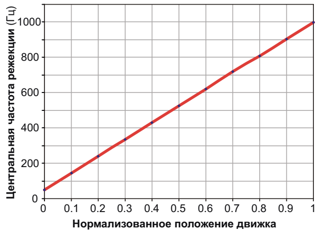
Рисунок 4. Смоделированная в Spice зависимость центральной частота режекции схемы на Рисунке 3 от нормализованного положения движка показывает, что центральная частота является линейной функцией положения регулятора.
