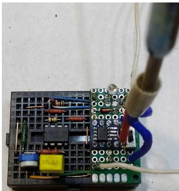
Рисунок 2. Прототип контроллера паяльника на бесплаечной макетной плате.
