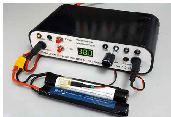
Рисунок 7. Восстановленное зарядное устройство в процессе заряда страйкбольного NiMH аккумулятора с номинальным напряжением 9.6 В.
