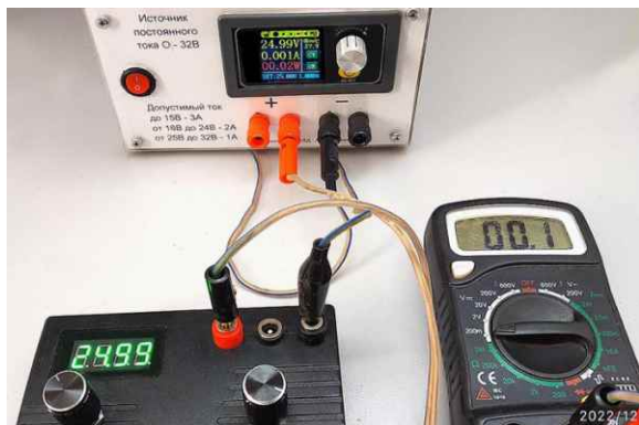
Рисунок 4. Пример практического применения вспомогательного источника при измерении с высоким разрешением.
