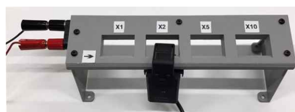
Рисунок 1. Изображение калибровочной станции для датчика тока с разъемным сердечником с установленным датчиком Холла.
