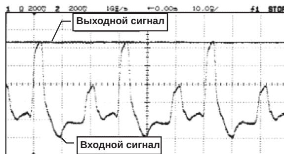
Рисунок 2. Постоянное выходное напряжение схемы на Рисунке 1 равно значению положительного пика входного сигнала.
