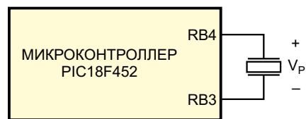
Рисунок 2. Микроконтроллер PIC18F452 сначала возбуждает пьезоэлектрический зуммер на запрограммированной частоте, а затем настраивает один из его выводов на вход для подсчета числа остаточных колебаний.
