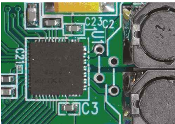
Рисунок 3. Широкие печатные проводники справа от микросхемы усилителя класса D помогают отводить тепло от устройства к соседним компонентам.
