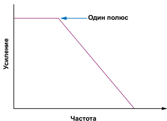
Рисунок 2. На диаграмме Бодэ регулятора с токовым управлением есть только один простой полюс, вносимый силовым каскадом.
