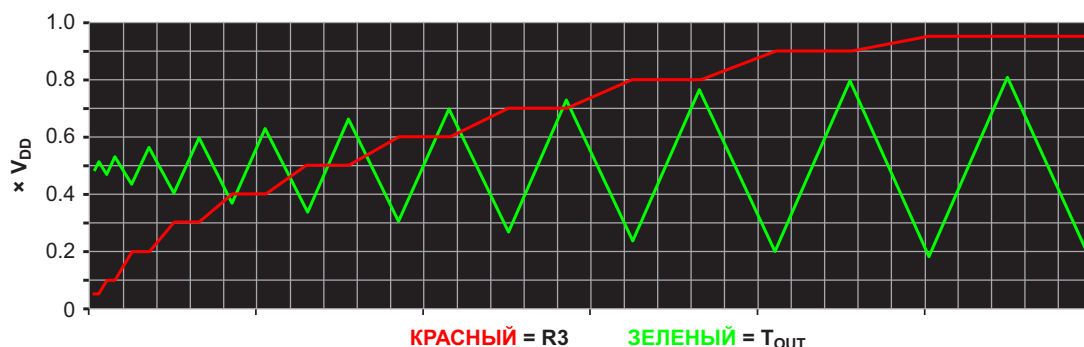
Рисунок 3. Зависимость амплитуды T_{OUT} от положения движка потенциометра R_3 . (0 – поворот против часовой стрелки до упора, 1 – поворот по часовой стрелке до упора).
