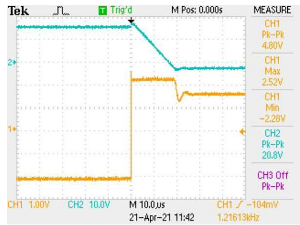
Рисунок 6. Осциллограммы сигналов схемы на Рисунке 4 показывают, что основным ограничением времени отклика является скорость нарастания выходного напряжения операционного усилителя. Подробности см. в тексте.
