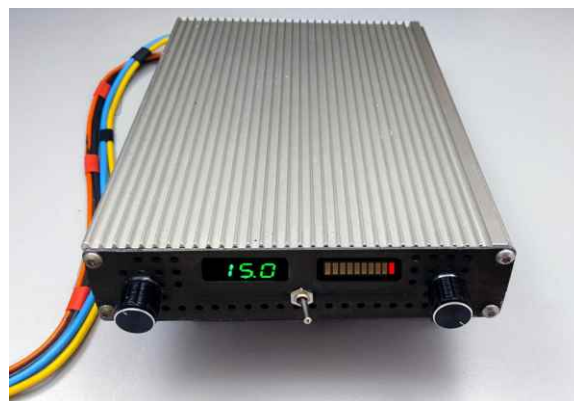
Рисунок 2. Лицевая панель стабилизатора тока с индикацией положения коммутатора и величины тока в нагрузке
