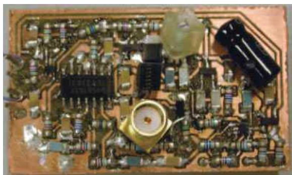
Рисунок 4. В прототипе сверхрегенеративного приемника в основном используются компоненты для поверхностного монтажа. Большой черный компонент с выводами в правом верхнем углу представляет собой конденсатор развязки по питанию. Обратите внимание на высокочастотный входной разъем в центре печатной платы.
