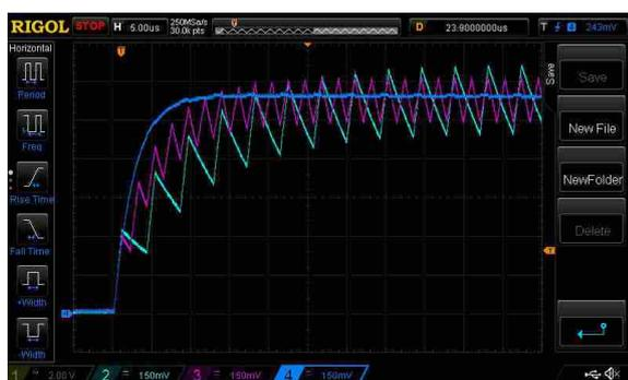
**Рисунок 2.** Схема с коэффициентом заполнения 25%.
