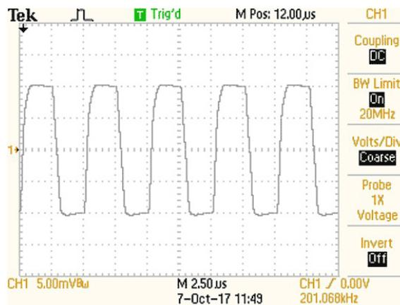
**Рисунок 7.** При частоте прямоугольных импульсов 200 кГц Простой источник демонстрирует достойные характеристики, поскольку индуктивная нагрузка не входит в контур обратной связи. Компенсация устраняет звон, обусловленный влиянием выходной емкости.
