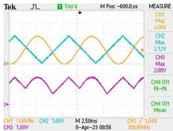
**Рисунок 3.** Осциллограммы сигналов в двухканальной версии усилителя с выбором приоритетного входа. Каналы 1 и 2 – входные сигналы, Канал 3 – выход. (Обратите внимание, что нулевой уровень Канала 3 на экране осциллографа находится ниже, чем уровни Каналов 1 и 2).
