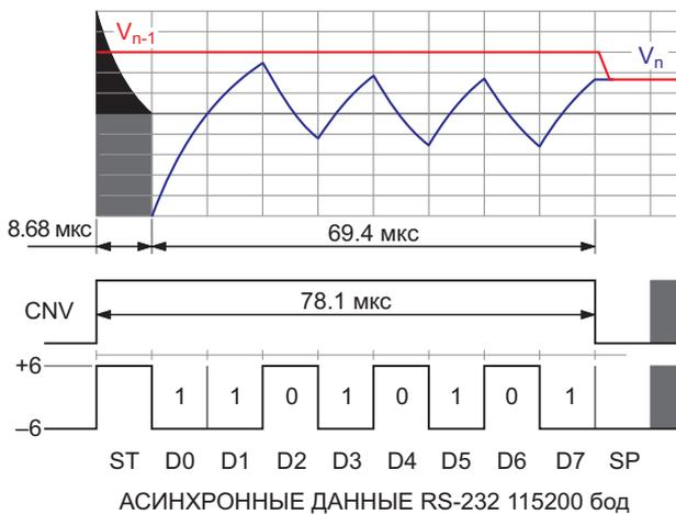
**Рисунок 5.** Временная диаграмма преобразования SDD для сигналов с уровнями RS-232.
