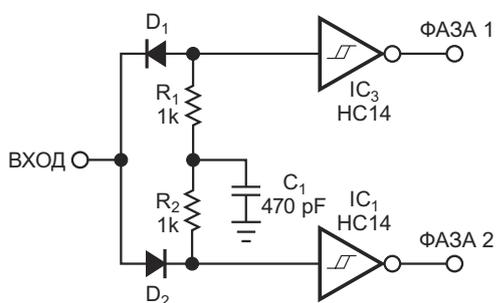
**Рисунок 1.** Каждый инвертор с триггером Шмитта управляется в течение одного полупериода через диод. Создаваемая RC-цепью задержка происходит во время чередования полупериодов. Резисторы с равными сопротивлениями  $R_1$  и  $R_2$  попеременно служат в качестве элементов задержки и резисторов связи инверторов.
