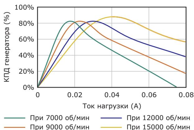
**Рисунок 6.** Зависимость КПД от тока нагрузки для двигателя 16С18.
