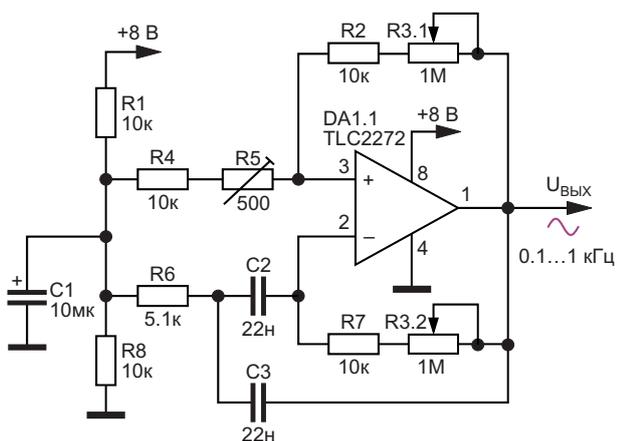
**Рисунок 2.** Генератор сигналов синусоидальной формы с перестройкой частоты в пределах декады.
