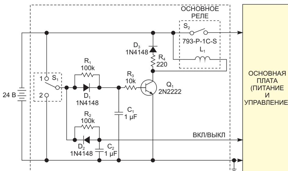
Рисунок 1. Для отключения батарейного питания в этой схеме использует реле.
