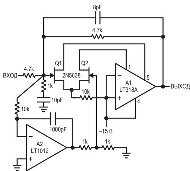
**Рисунок 4.** Идея Джима Уильямса, предложенная в 1986 году. Здесь Джим расширил идею, чтобы снизить дрейф за счет использования топологии Голдберга.
