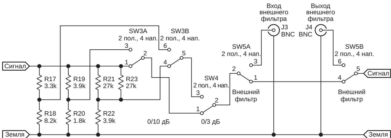
**Рисунок 4.** Принципиальная схема аттенюаторов 3/10/13 дБ и разъемов внешнего фильтра.
