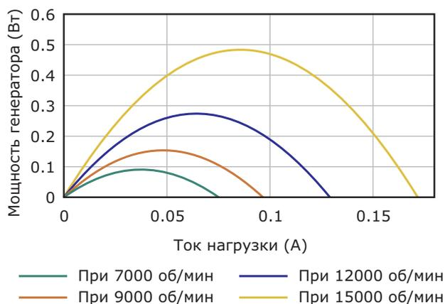
**Рисунок 5.** Зависимость выходной мощности от тока нагрузки для двигателя 16С18.
