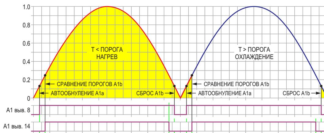
**Рисунок 2.** Цикл измерения/регулирования температуры с двумя циклами работы термостата по 8.33 мс, где каждый из этих циклов состоит из четырех этапов: автообнуление, сравнение порогов, нагрев/охлаждение и сброс A1b.
