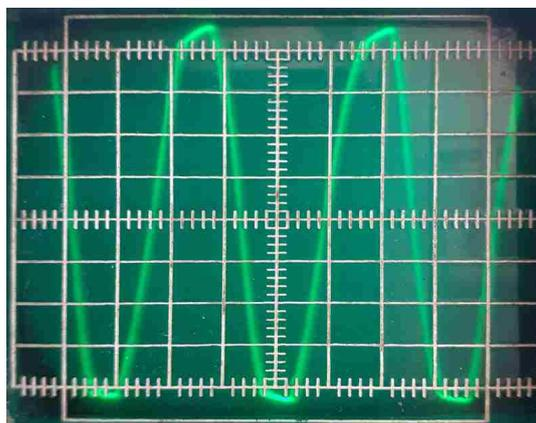
Рисунок 5. Ограничение сигнала на частоте 20 кГц.
