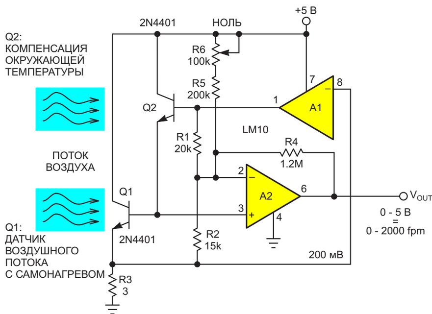
**Рисунок 2.** Самоподогревающийся тепловой датчик скорости воздушного потока на основе пары Дарлингтона.
