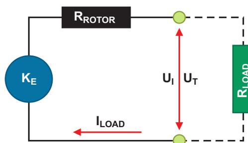
**Рисунок 1.** Эквивалентная схема двигателя постоянного тока, используемого в качестве генератора.
