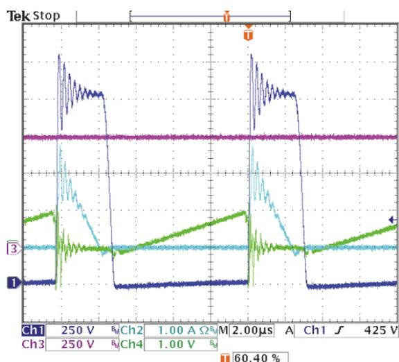
**Рисунок 2.** Когда ток вторичной обмотки достигает 0 А, MOSFET включается, и ток первичной обмотки нарастает от нуля.
