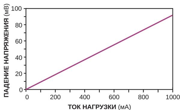
**Рисунок 2.** Падение напряжения в схеме на Рисунке 1 изменяется от 10 мВ при токе нагрузки 100 мА до 90 мВ при токе 1 А.
