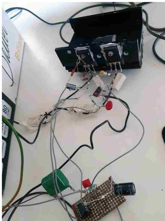
**Рисунок 2.** Первая проба навесным монтажом.
