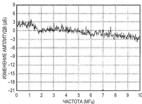
**Рисунок 4.** Зависимость среднеквадратичного значения шума от частоты в полосе 5 МГц имеет небольшой спад за пределами 1 МГц.
