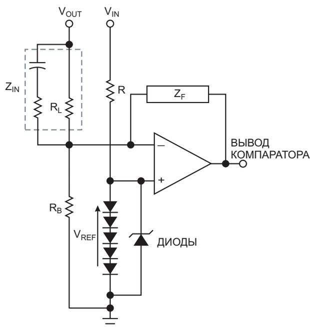
**Рисунок 7.** Изменение сопротивления  $R_B$  регулирует уставку напряжения преобразователя SEPIC для соответствия различным напряжениям солнечных панелей. Параметры резистивного делителя  $R_T/R_B$  можно подобрать так, чтобы они соответствовали вырабатываемому платой датчика температуры опорному напряжению преобразователя SEPIC, которое при 25 °C обычно составляет 1.34 В.
