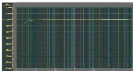
Рисунок 9. Частотная характеристика при входном сигнале 10 мВ в диапазоне 10 мВ.
