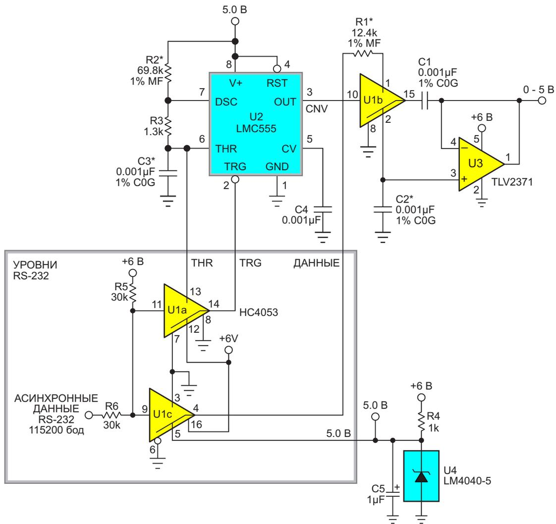
**Рисунок 4.** SDD, модифицированный для уровней и полярности сигналов интерфейса RS-232.
