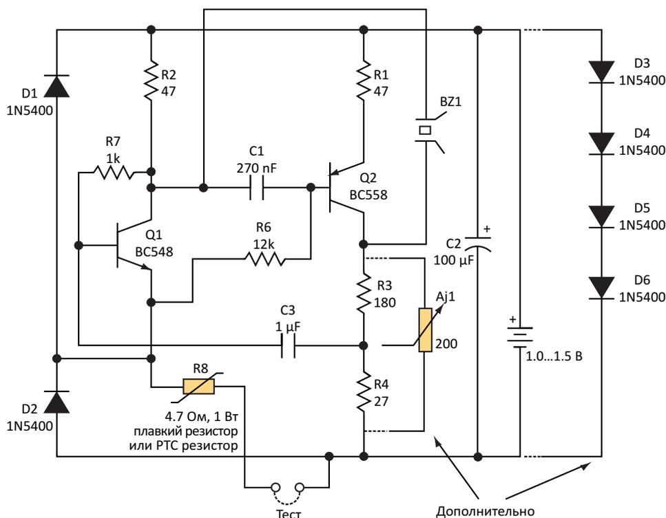
**Рисунок 1.** Несмотря на относительную простоту, эта схема тестера превосходит многие мультиметры и звуковые пробники в качестве тестера целостности цепей. Она также недорога в изготовлении и эксплуатации.
