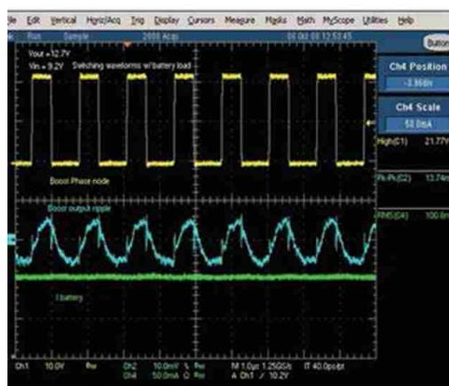
**Рисунок 12.** Типичные осциллограммы сигналов преобразователя: нагрузка аккумулятора (вверху), пульсации выходного тока (внизу).
