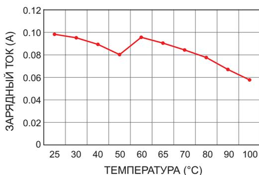
**Рисунок 10.** Нормальная рабочая температура зарядного устройства составляет 60 °С.
