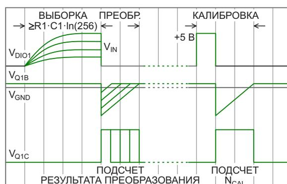
Рисунок 2. Фазы выборки, преобразования и калибровки «бесплатного» АЦП. ( $V_{Q1C}$  – напряжение коллектора транзистора Q1).
