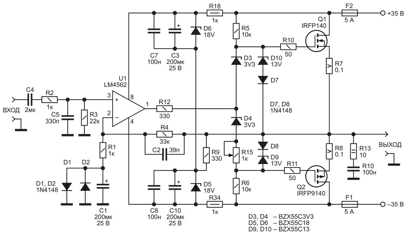
**Рисунок 1.** Схема УНЧ достоверного звучания.
