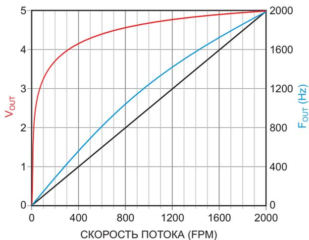
**Рисунок 7.** Антилогарифмическая линейаризация датчика скорости воздушного потока на транзисторе Дарлингтона.
