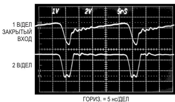
**Рисунок 2.** Работа ПНЧ на частоте 40 МГц. Осциллограммы сигналов задающего генератора, полученные на осциллографе реально времени с полосой пропускания 670 МГц, включают сигнал на коллекторе транзистора Q1 (осциллограмма А) и на эмиттере Q2 (осциллограмма В). Очевидна характеристика работы в режиме нарастания и сброса; длительность сброса 6 нс позволяет использовать частоту повторения 100 МГц.
