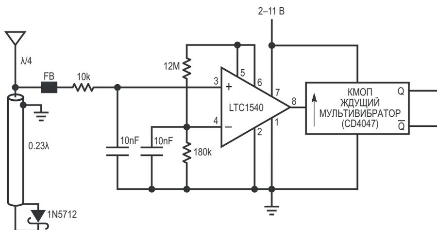
Рисунок 1. Микромощный детектор напряженности поля.
