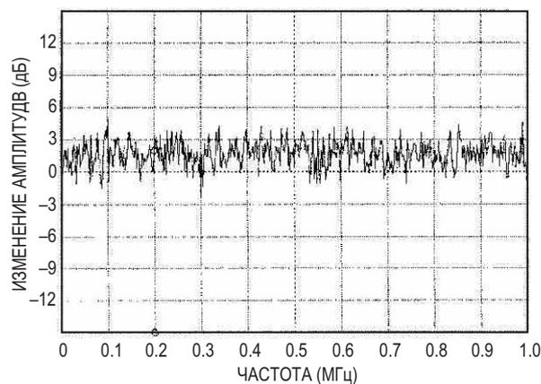
**Рисунок 3.** Зависимость амплитуды случайного шума от частоты имеет практически плоский характер в полосе до 1 МГц.
