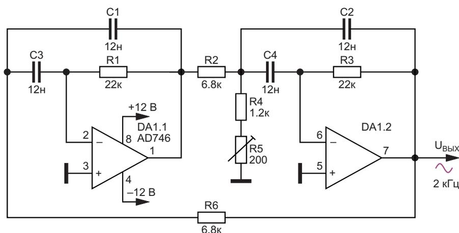
**Рисунок 1.** Генератор сигналов синусоидальной формы на основе последовательного включения фильтров Р.А. Пиза.
