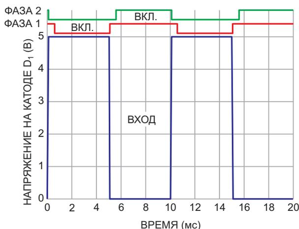
**Рисунок 2.** Для двух противофазных полупериодов передние фронты задерживаются одинаково относительно фронта входного импульса, а задние фронты совпадают с входным фронтом с точностью примерно до одной задержки в логическом элементе.
