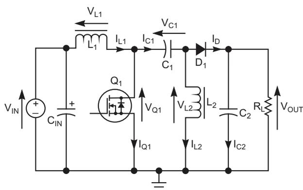
**Рисунок 4.** SEPIC – это топология DC/DC преобразователя, которая позволяет выходному напряжению быть больше, меньше или равным входному напряжению.
