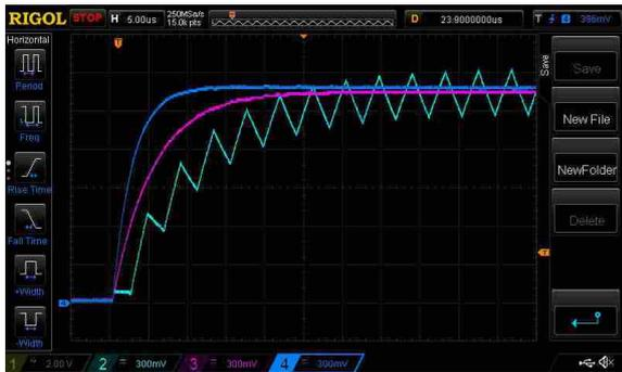
**Рисунок 3.** Схема с коэффициентом заполнения 50%.
