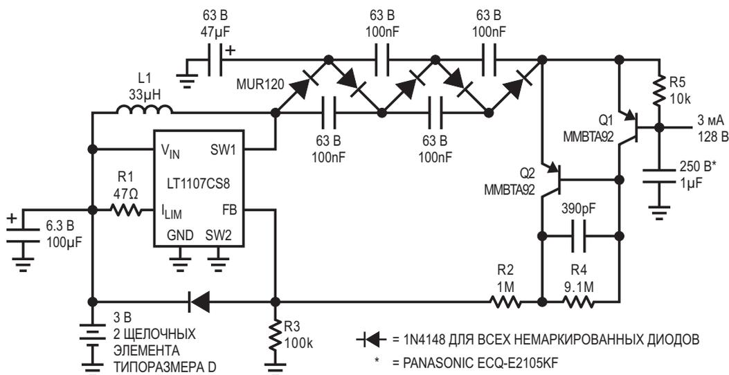
Рисунок 1. Автоматическое отключение снижает ток батареи до 350 мкА.
