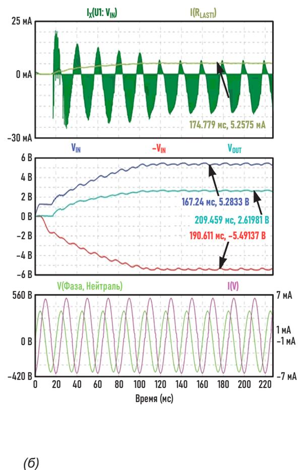
**Рисунок 6.** Осциллограммы критических точек схемы при запуске и во время нормальной работы при низком напряжении сети 184 В (а) и высоком напряжении сети 260 В (б) демонстрируют плавное включение и последующую стабилизацию.
