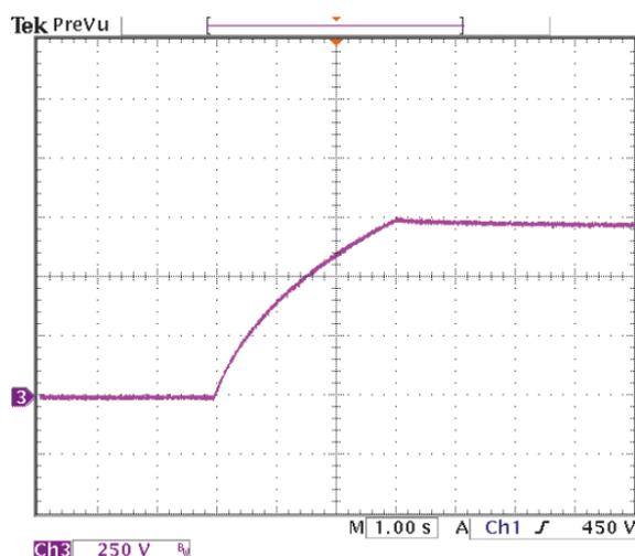
**Рисунок 3.** Напряжение на выходном конденсаторе достигает своего полного уровня примерно за 3 секунды.
