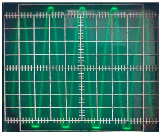
Рисунок 4. Ограничение сигнала на частоте 1 кГц.
