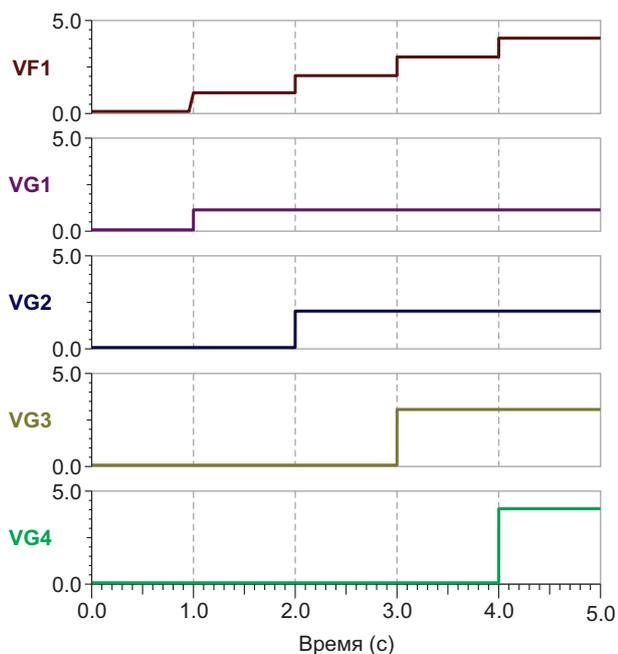
**Рисунок 2.** Сигналы смоделированного 4-канального усилителя с выбором приоритетного входа.
