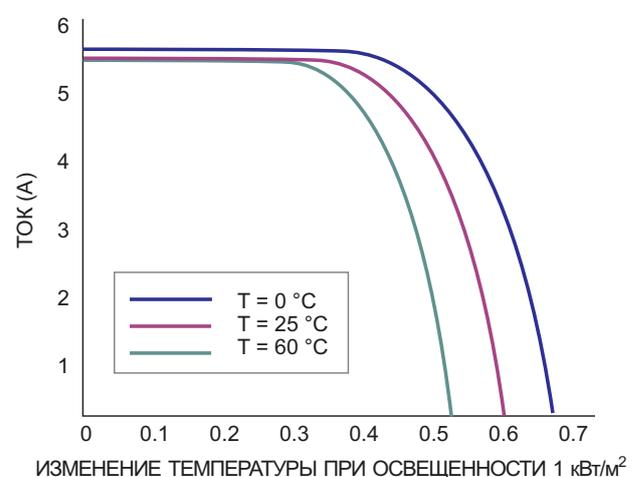
**Рисунок 2.** Выходное напряжение солнечного элемента уменьшается с повышением температуры.
