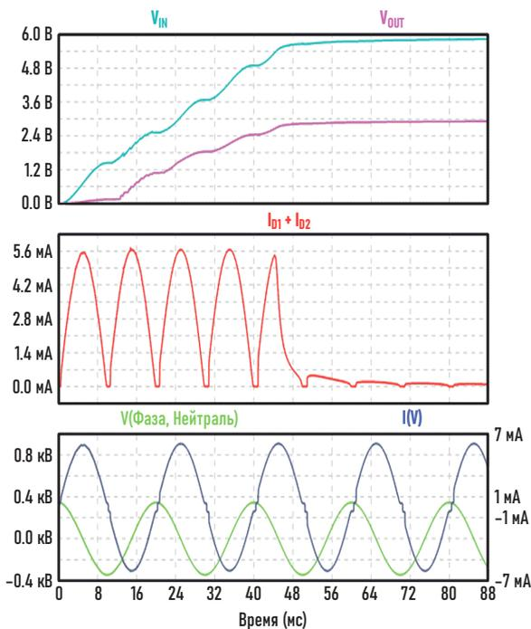
**Рисунок 3.** Конденсатор C1 должен питать остальную часть схемы на Рисунке 2 в течение очень коротких периодов времени.
