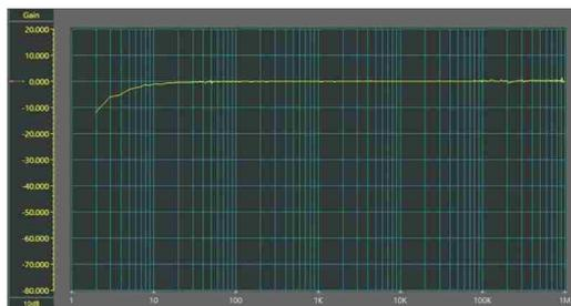
Рисунок 10. Частотная характеристика при входном сигнале 1 мВ в диапазоне 1 мВ.
