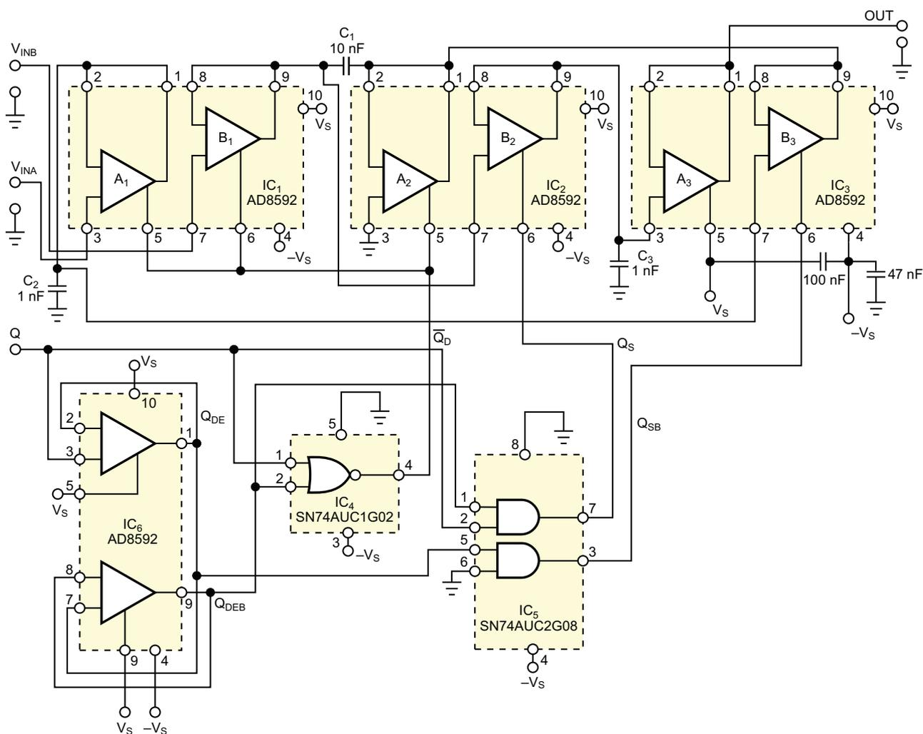
**Рисунок 1.** Основой работы этой схемы является одновременное отслеживание входных напряжений  $V_{INA}$  и  $V_{INB}$  на конденсаторах  $C_2$  и  $C_1$ , суммирование напряжений этих конденсаторов в интервале выборки и сохранение суммарного напряжения на конденсаторе  $C_3$ .
