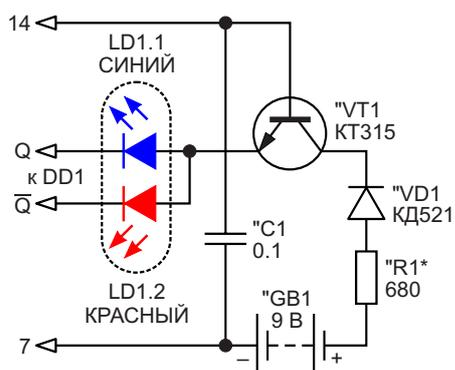
Рисунок 7. Подключение источника питания.
