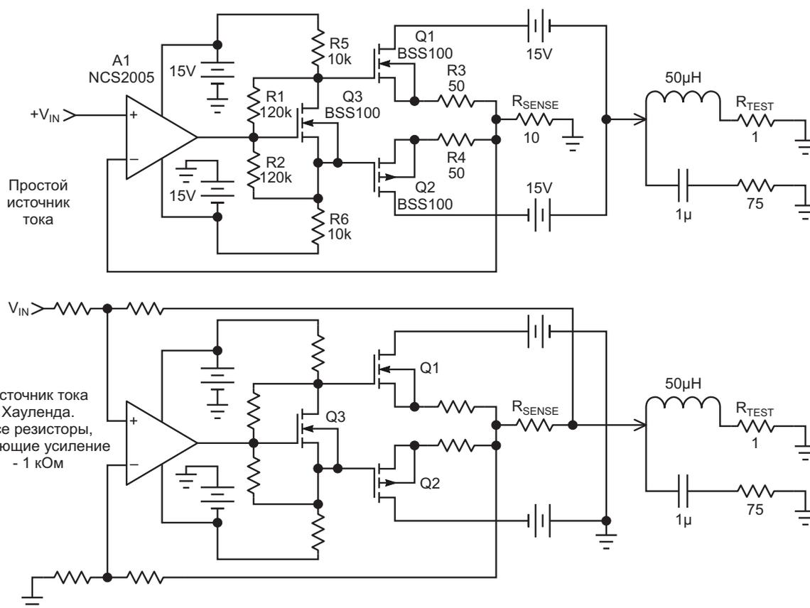
**Рисунок 5.** Тестовые схемы для сравнения динамических характеристик Простого источника (вверху) и схемы Хауланда (внизу). Выходной сигнал наблюдался на резисторе  $R_{TEST}$ .
