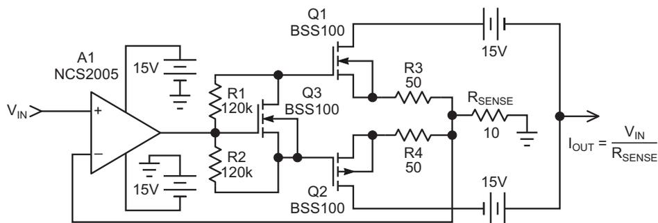
**Рисунок 3.** Реальная схема, использованная при тестировании источника тока для заземленной нагрузки. 50-омные резисторы в истоках транзисторов Q1 и Q2 устраняют злон MOSFET при быстрых переходах. В эту схему включен транзистор Q3 умножителя напряжения затвор-исток, обеспечивающий смещение для работы в режиме A/B, необходимом при тестировании высокочастотных переходных характеристик.
