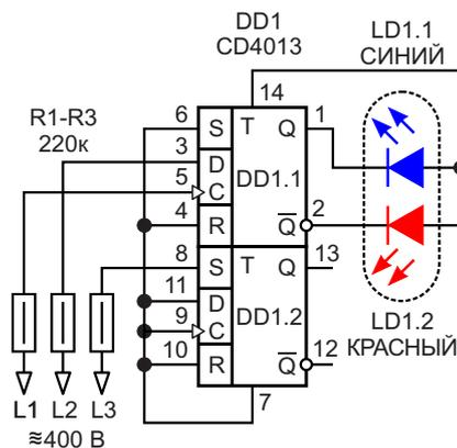
**Рисунок 4.** Схема с применением CD4013.
