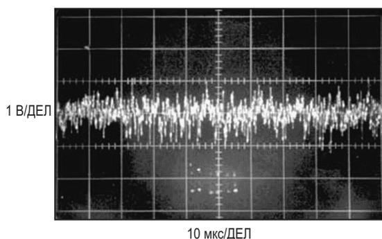
**Рисунок 2.** Оциллограмма выходного сигнала схемы на Рисунке 1 при положении переключателя диапазонов «1 МГц».
