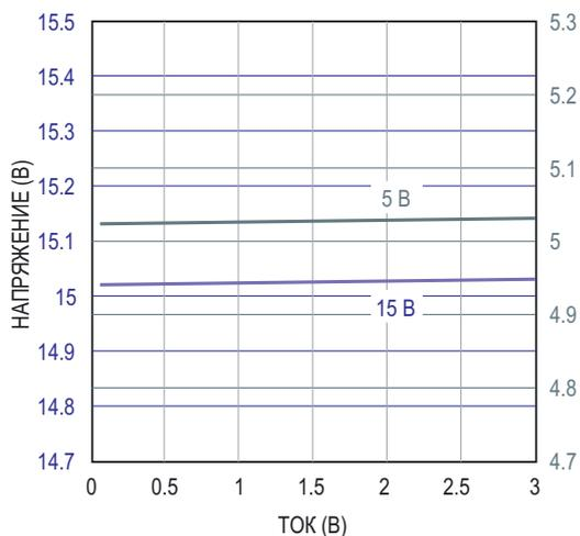
**Рисунок 2.** Способность имитатора аккумулятора поглощать ток при напряжениях 5 В и 15 В.
