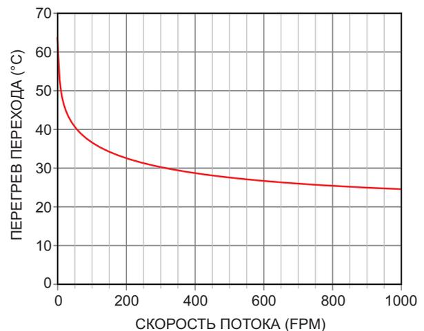
**Рисунок 1.** Изменение температуры перехода транзистора в корпусе TO-92 при рассеиваемой мощности 320 мВт показывает нелинейную зависимость между воздушным потоком и температурой датчика.
