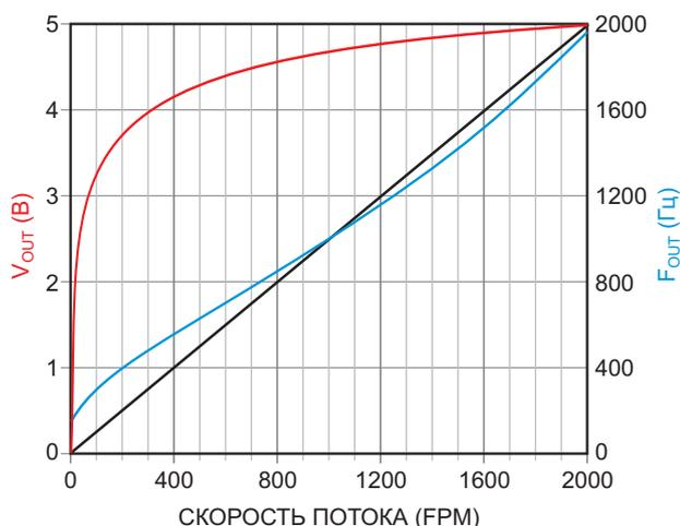
**Рисунок 4.** *Линеаризованный с помощью ПНЧ отклик на скорость воздушного потока (синяя кривая). Теперь увеличение зависимости частоты от скорости потока компенсирует эффект закона Кинга (красная кривая), чтобы получить 1 Гц = 1 fpm.*
