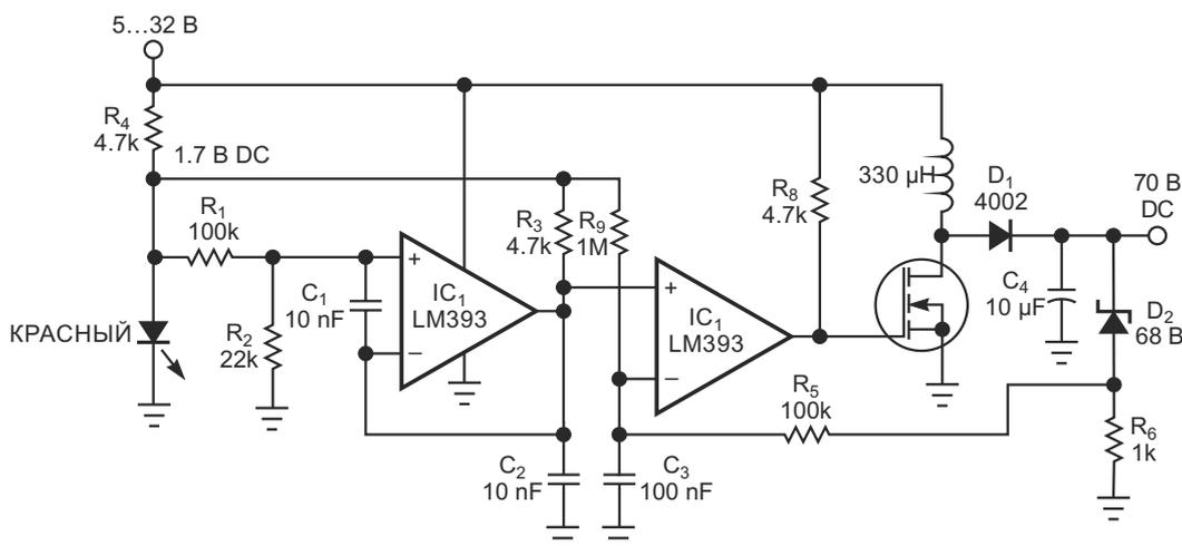
**Рисунок 2.** Использование генератора пилообразного напряжения в 70-вольтовом повышающем DC/DC преобразователе.
