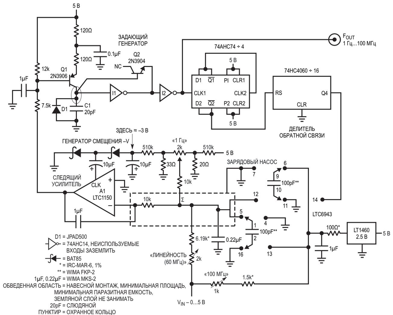
**Рисунок 1.** Преобразователь напряжение-частота 1 Гц – 100 МГц имеет динамический диапазон 160 дБ и работает от источника питания 5 В. Смещенный по входу следящий усилитель управляет задающим генератором, стабилизируя рабочую точку схемы. Широкий рабочий диапазон обусловлен характеристиками задающего генератора, обратной связью на основе делителя/зарядового насоса и низкими входными ошибками по постоянному току усилителя А1.
