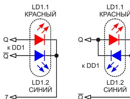
**Рисунок 6.** Варианты подключения светодиодов.
