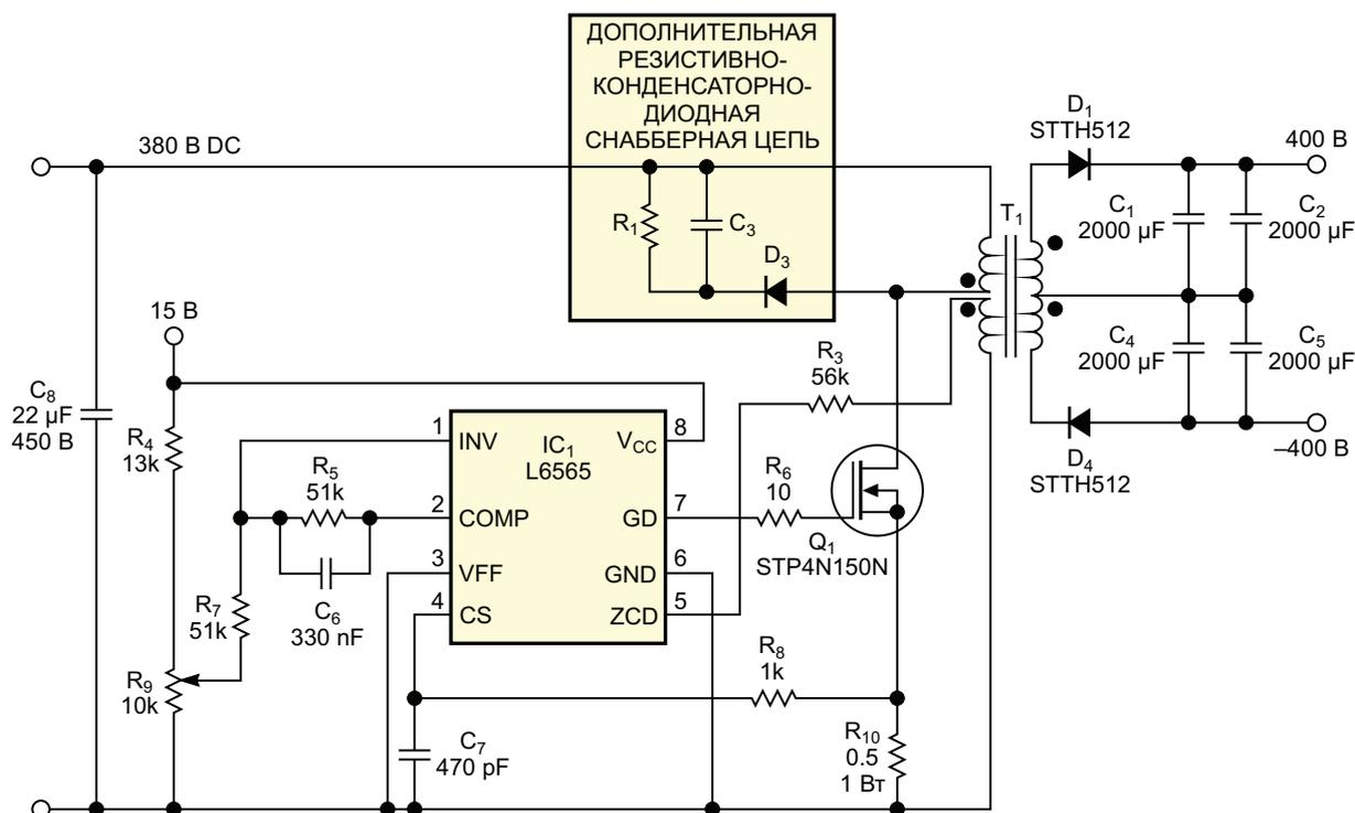
**Рисунок 1.** Обратноеходовое зарядное устройство для конденсаторов работает в режиме граничной проводимости.
