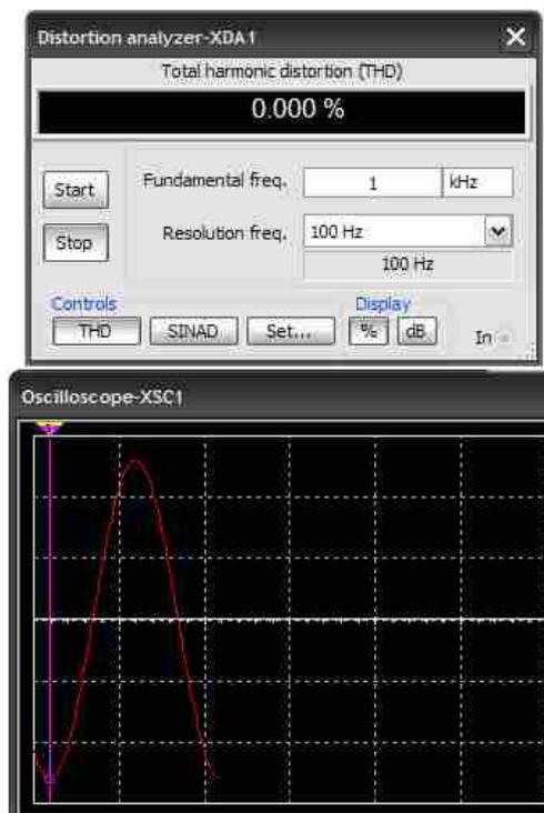
Рисунок 7. Измерение нелинейных искажений.
