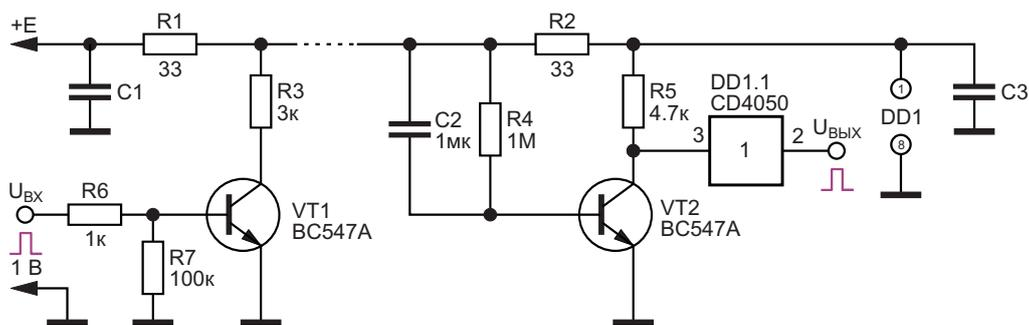
**Рисунок 2.** Передача цифровой информации через цепь питания с использованием транзисторных усилителей, а также КМОП(ТТЛ)-повторителя напряжения на приемной стороне.
