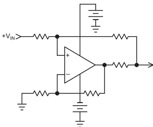
**Рисунок 1.** Классическая улучшенная схема Хаулленда используется в качестве двунаправленного источника тока для заземленных нагрузок. Для достижения высокой точности и хороших характеристик эта схема требует строгого подбора и согласования номиналов компонентов.
