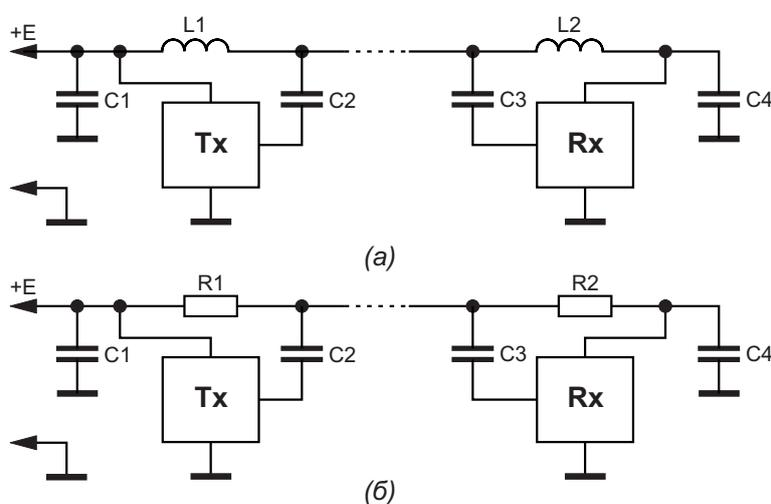
Рисунок 1. Основные способы передачи информации по цепям питания с использованием разделительных: (а) дросселей; (б) резисторов.
