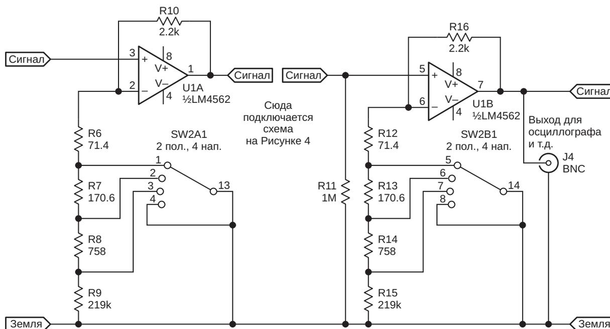
**Рисунок 3.** Первый и второй усилители и переключатель диапазонов.
