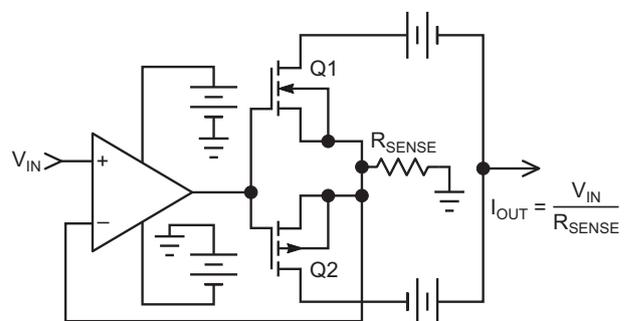
**Рисунок 2.** Эта простая схема источника тока обеспечивает высокую точность с помощью единственного резистора за счет плавающих источников питания выходного каскада. Как покажет проверка на веб-сайте вашего любимого дистрибьютора, двухканальные изолированные DC/DC преобразователи легко доступны для разных уровней мощности.
