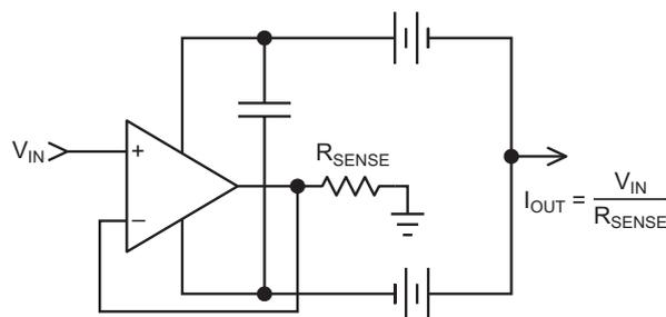
**Рисунок 8.** Простейшая возможная реализация токового выхода в этой схеме с более низким выходным сопротивлением и ограниченными выходными характеристиками. Кроме того, необходимо будет проверить работоспособность выбранного операционного усилителя в этой схеме, так как некоторые типы могут работать плохо из-за плавающих источников питания. (Если вы не склонны к авантюрам, сопротивление  $R_{SENSE}$  должно быть больше 1 кОм).
