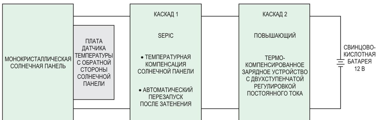
**Рисунок 3.** В зарядном устройстве в качестве входного источника используется 18-элементная 3-ваттная солнечная панель. Система состоит из двух каскадов, первый из которых контролирует напряжение солнечной панели и вырабатывает напряжение, которое отслеживает изменение выходного напряжения солнечной панели в диапазоне температур.
