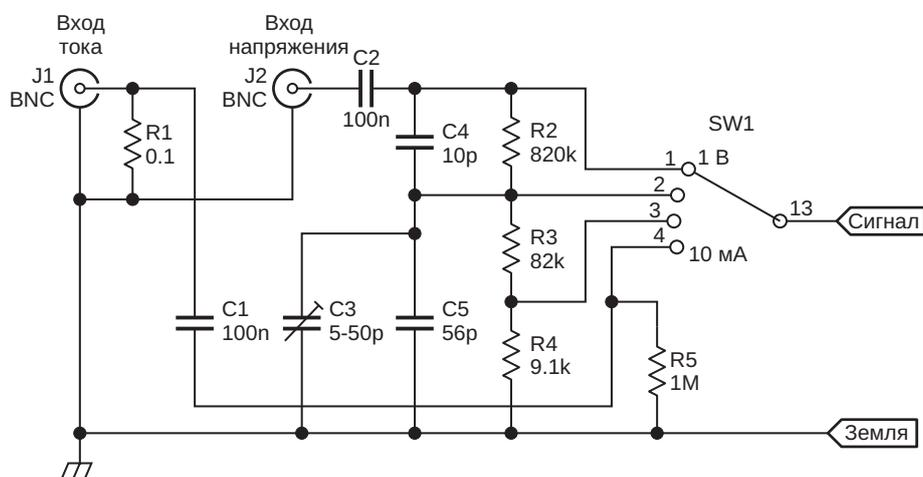
Рисунок 2. Входной аттенюатор и переключатель ток/напряжение.
