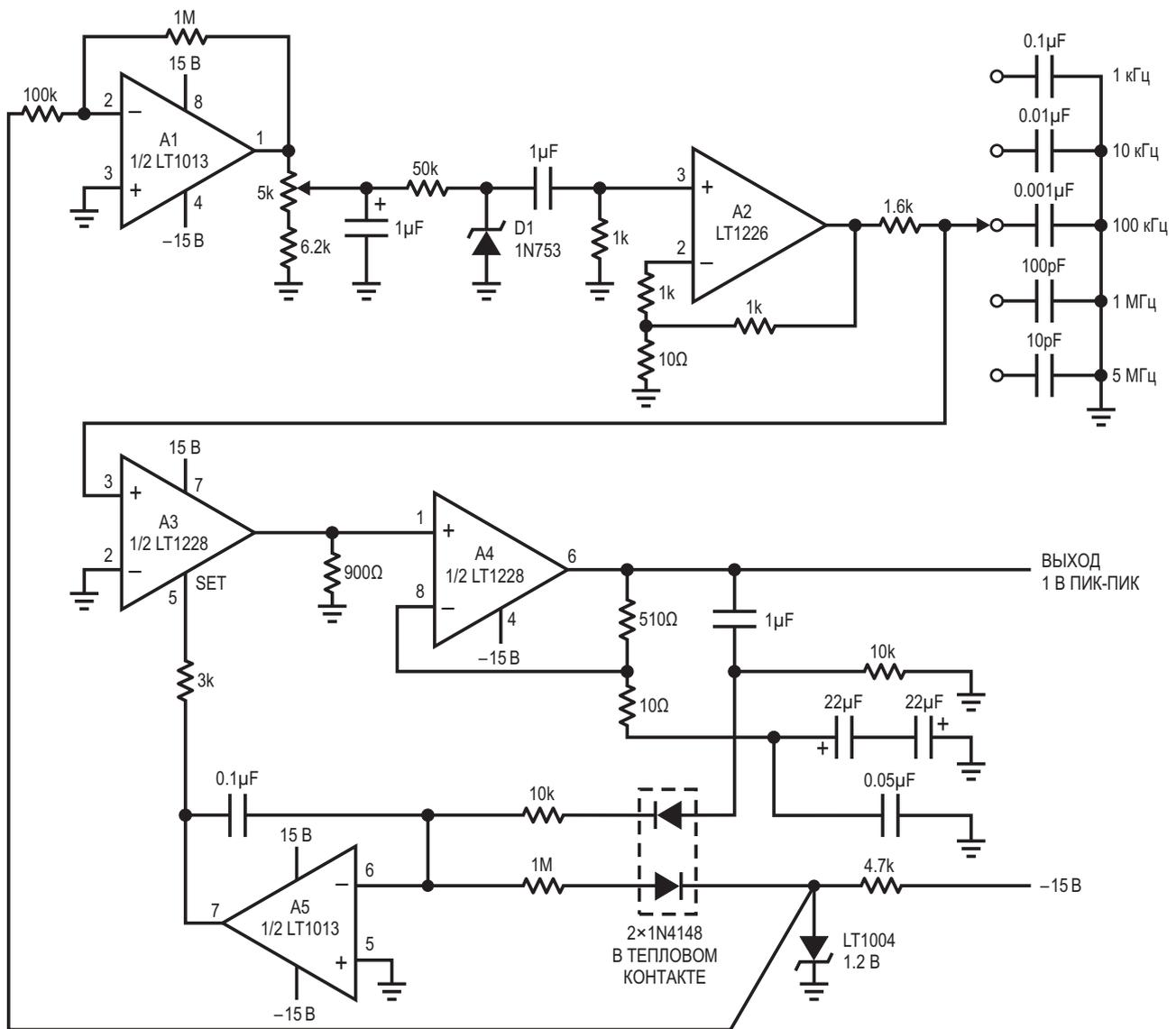
**Рисунок 5.** В аналоговой схеме используется стандартный стабилитрон, но эта схема сложнее и требует регулировки.
