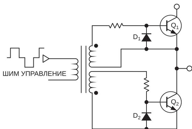
**Рисунок 1.** Медленные диоды можно использовать для формирования мертвого времени в полумостовой конфигурации.
