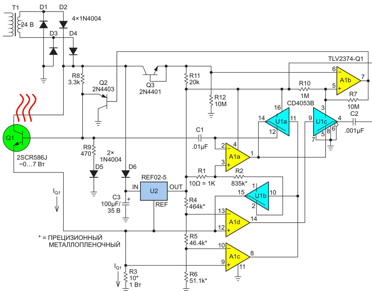
**Рисунок 1.** Термостат на основе  $\Delta V_{BE}$  мощного самоподогреваемого биполярного транзистора с мультиплексированием функций, находящегося в плотном тепловом контакте с компонентом, требующим контроля температуры, и с датчиком  $V_{BE}$  для измерения температуры.
