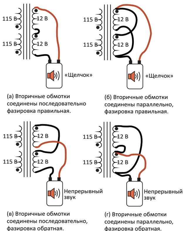
**Рисунок 2.** Показаны некоторые из тестов, которые можно выполнить с помощью тестера целостности на трансформаторе с двумя первичными и двумя вторичными обмотками без необходимости подключения его к сети.
