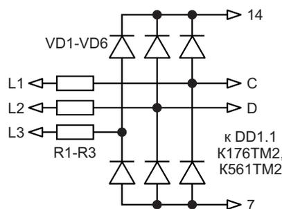
**Рисунок 5.** Подключение внешнего диодного моста.
