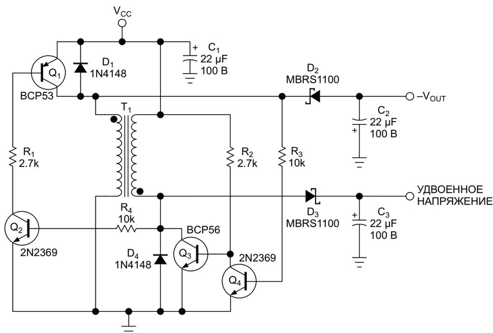
**Рисунок 1.** Регенеративная схема с перекрестной связью управляет переключением транзисторов  $Q_1$  и  $Q_3$  и обмотками трансформатора. Результирующие импульсы напряжения на их коллекторах выпрямляются до удвоенного положительного и до отрицательного напряжения питания.
