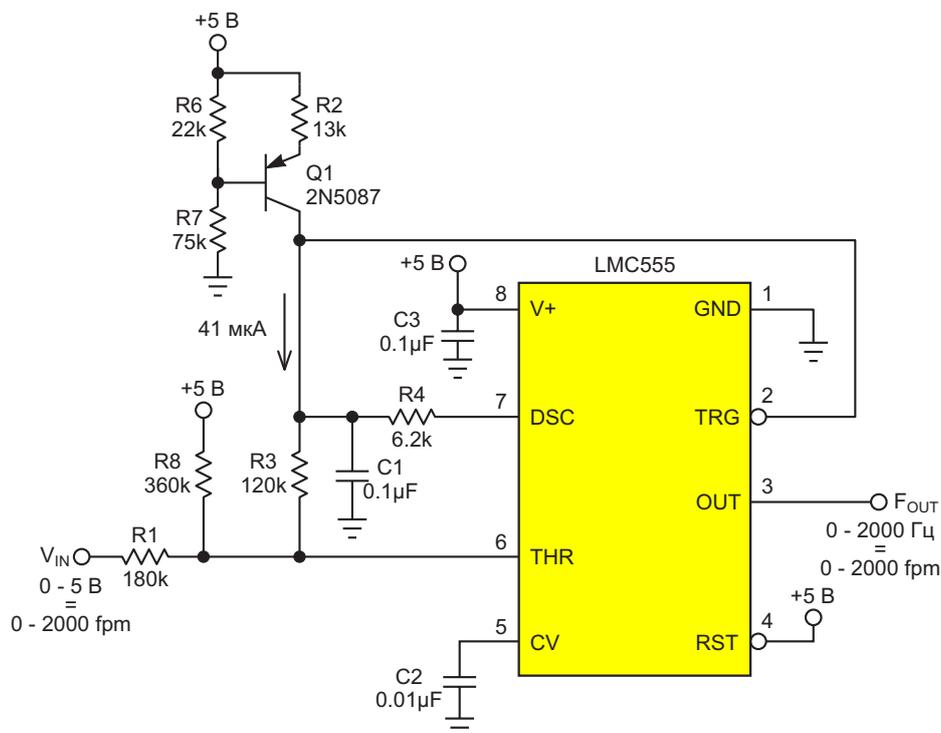
**Рисунок 3.** Показан нелинейный ПНЧ на основе таймера 555, сконфигурированного в автоколебательной топологии, и резисторной цепочки, подключенной к  $V_{IN}$ , что обеспечивает решение проблемы предыдущей нелинейности.
