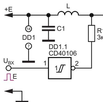
**Рисунок 4.** Передатчик цифровой информации через цепь питания, вариант.
