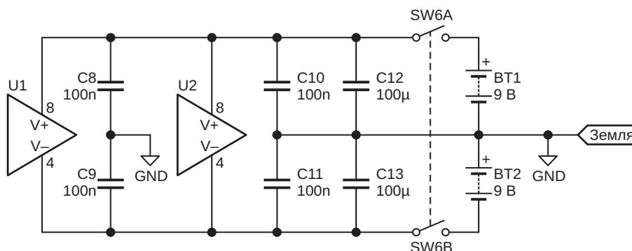
**Рисунок 6. Принципиальная схема источника питания.**
