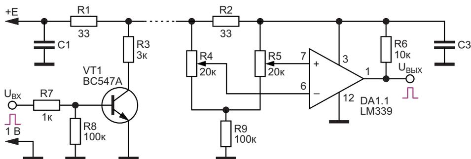
**Рисунок 3.** Передача цифровой информации через цепь питания с использованием компаратора на приемной стороне.
