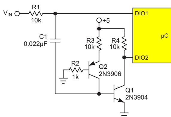
Рисунок 1. Схема «бесплатного» (почти) АЦП.
