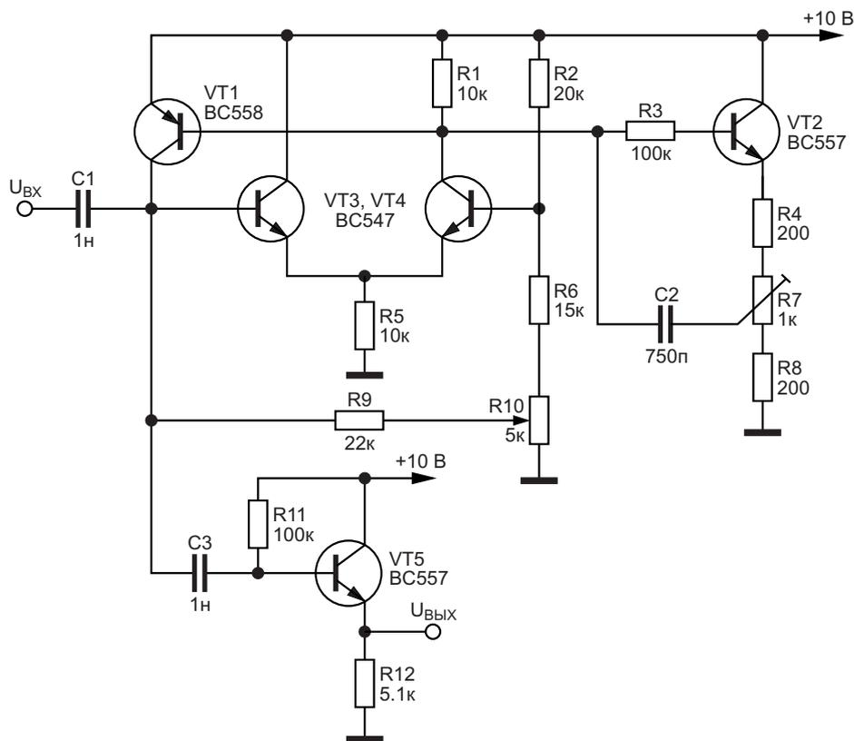
**Рисунок 2.** Гираторный фильтр с перестройкой резонансной частоты электронным аналогом конденсатора переменной емкости на основе повторителя напряжения.
