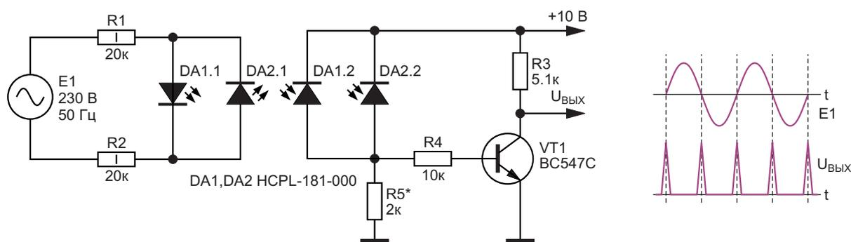
Рисунок 1. Индикатор перехода сетевого напряжения через ноль с использованием двух оптронов.
