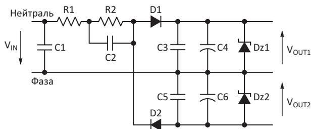
**Рисунок 1.** В базовом емкостном преобразователе используются диодный выпрямитель, стабилитроны и конденсаторы, но отсутствует стабилизация.
