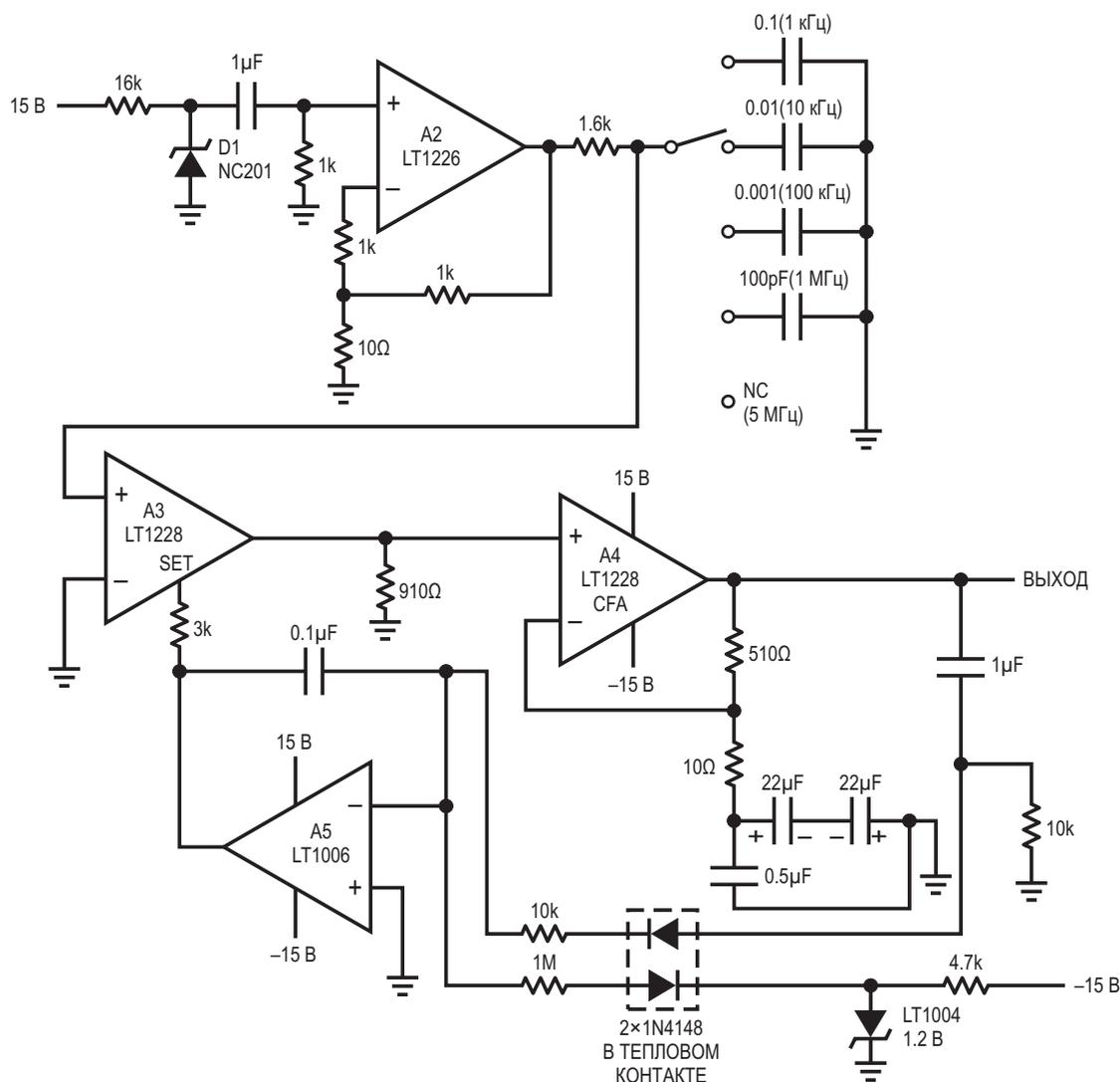
Рисунок 1. Для улучшения равномерности амплитуды спектра шумов в широкополосном генераторе случайного шума используется контур управления усилением.
