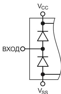
**Рисунок 3.** Входные защитные диоды.
