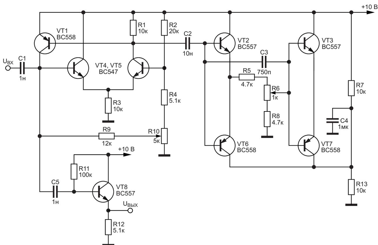
Рисунок 1. Гираторный фильтр с перестройкой резонансной частоты электронным аналогом конденсатора переменной емкости Дж. Гаона.
