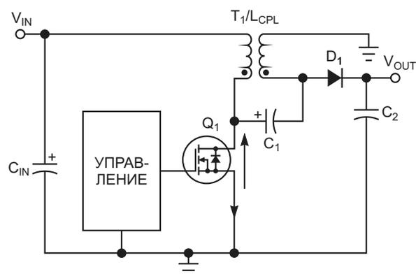
**Рисунок 5.** Замена дросселя  $L_2$  на Рисунке 4 дает изолированную топологию SEPIC.
