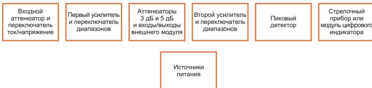
**Рисунок 1.** Блок схема широкополосного аналогового измерительного прибора.
