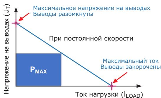
**Рисунок 2.** Зависимость тока нагрузки от напряжения на выводах.
