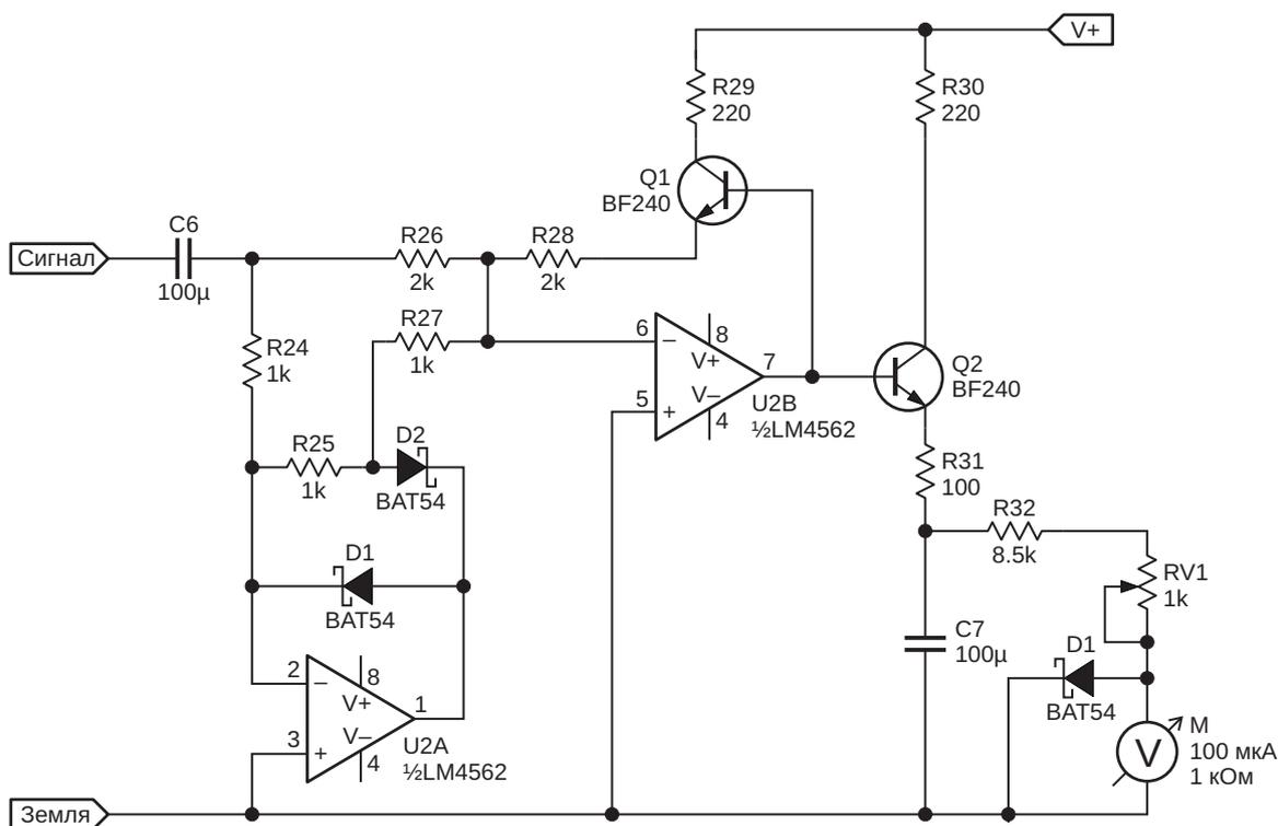
**Рисунок 5.** Принципиальная схема пикового детектора.
