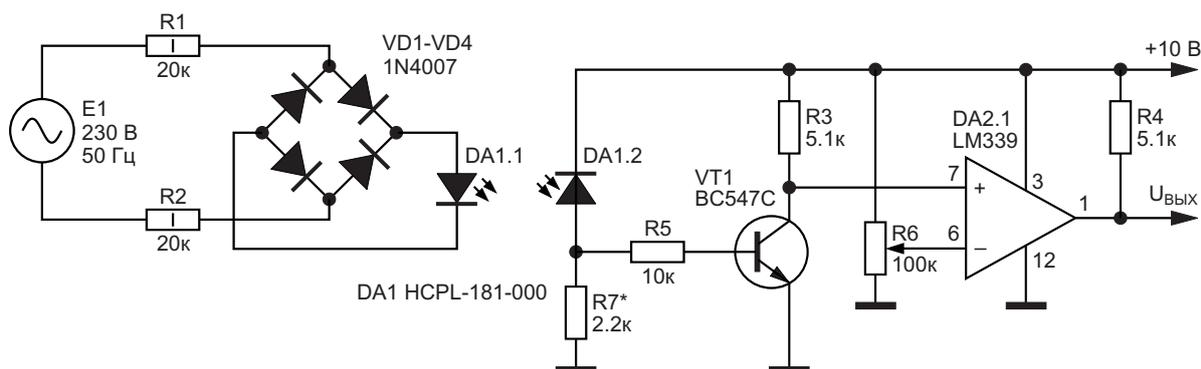
**Рисунок 3.** Индикатор перехода сетевого напряжения через ноль с оптоэлектронной развязкой, каскадом предусилителя и компаратора.
