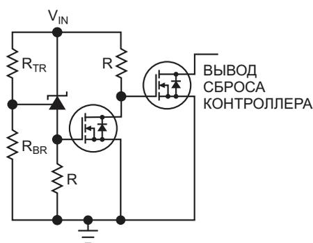
**Рисунок 9.** Делитель  $R_{BR}/R_{TR}$ , подключенный к микросхеме LM4041 в первом каскаде, воспринимает выходное напряжение солнечной панели и инициирует режим перезапуска, отключая второй каскад схемы путем подтягивания к земле вывода разрешения LM5001.
