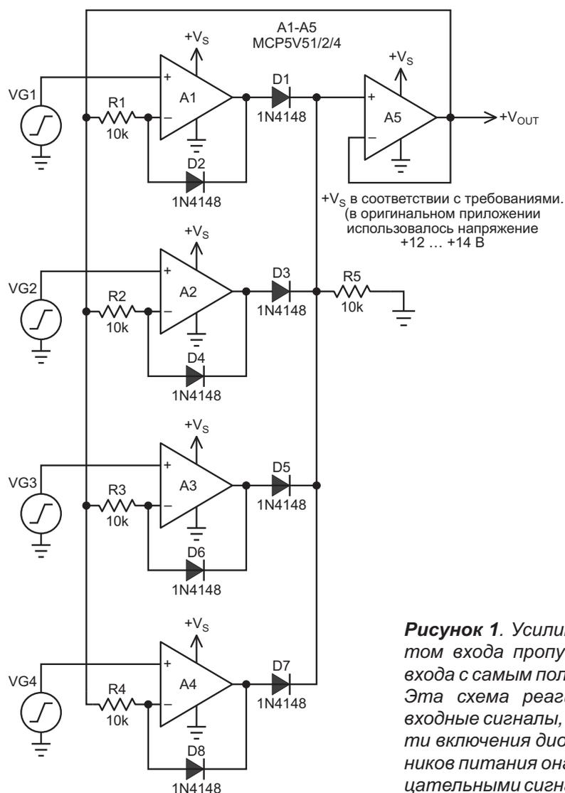
**Рисунок 1.** Усилитель с выбором приоритетом входа пропускает на выход сигнал со входа с самым положительным напряжением. Эта схема реагирует на положительные входные сигналы, но при изменении полярности включения диодов и конфигурации источников питания она может работать с отрицательными сигналами.
