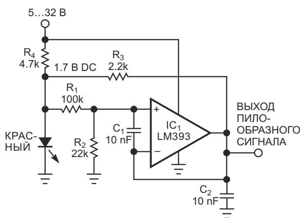
**Рисунок 1.** Этот генератор пилообразного напряжения можно использовать в цепях ШИМ недорогих импульсных DC/DC преобразователей.
