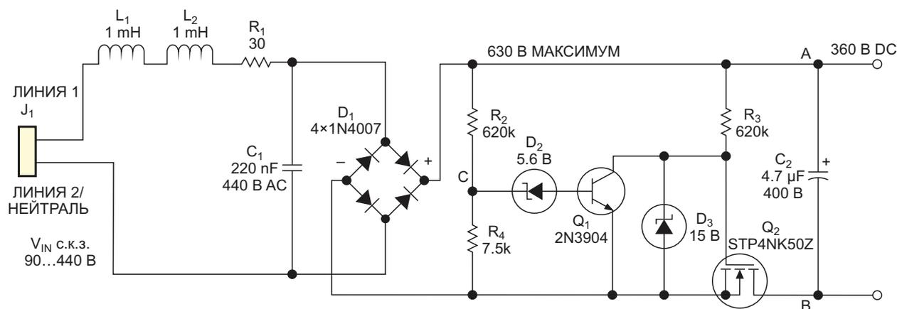
Рисунок 1. Схема прерывателя снижает напряжение шины питания до уровня менее 400 В DC.
