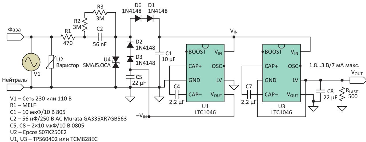
**Рисунок 4.** Модифицированный емкостной преобразователь без мостового выпрямителя имеет фиксированное соединение с землей.
