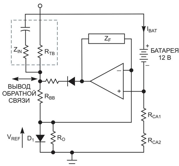
**Рисунок 8.** Второй каскад включает преобразователь SEPIC, работающий в режиме повышения напряжения со стабилизацией зарядного тока 12-вольтового аккумулятора.
