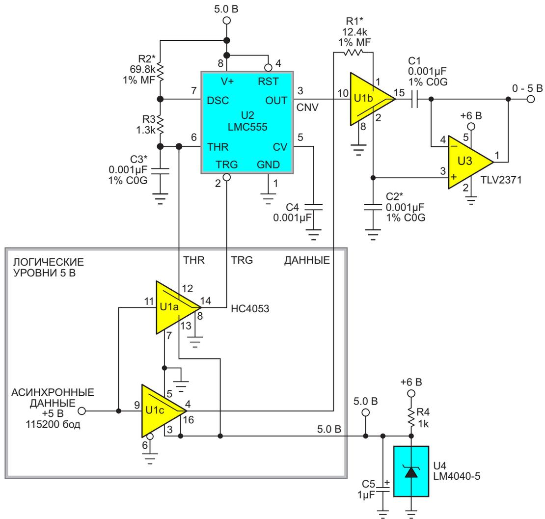
**Рисунок 2.** SDD с 5-вольтовыми уровнями асинхронных последовательных данных.
