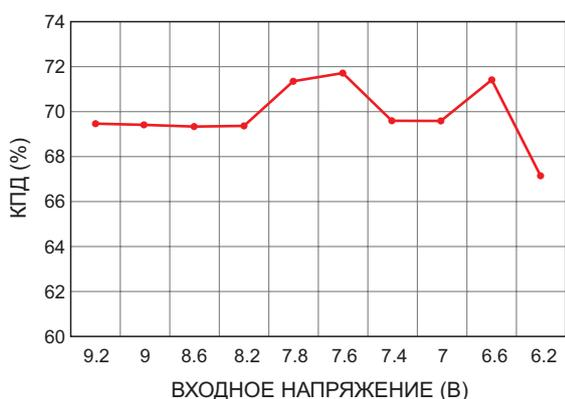
**Рисунок 11.** КПД быстро снижается, когда входное напряжение от солнечной панели падает ниже 6.5 В.
