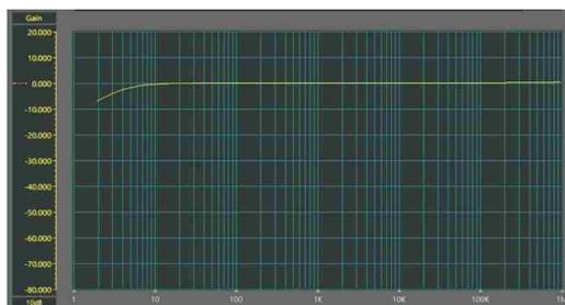
Рисунок 7. Частотная характеристика при входном сигнале 1 В в диапазоне 1 В.
