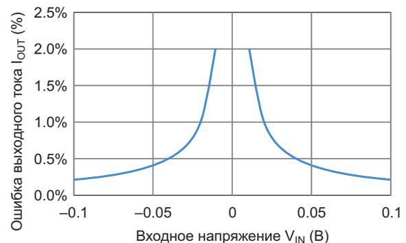
**Рисунок 4.** Выходная ошибка схемы на Рисунке 3 в диапазоне токов  $\pm 10$  мА.
