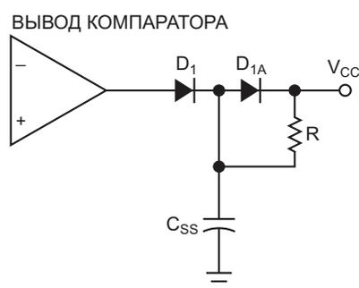
**Рисунок 6.** Для увеличения времени запуска, гарантирующего, что солнечная панель не перегрузится во время включения, в конструкцию включена внешняя схема мягкого запуска.
