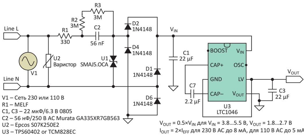
**Рисунок 2.** Модифицированный емкостной преобразователь с мостовым выпрямителем обеспечивает дополнительную стабилизацию и защиту.
