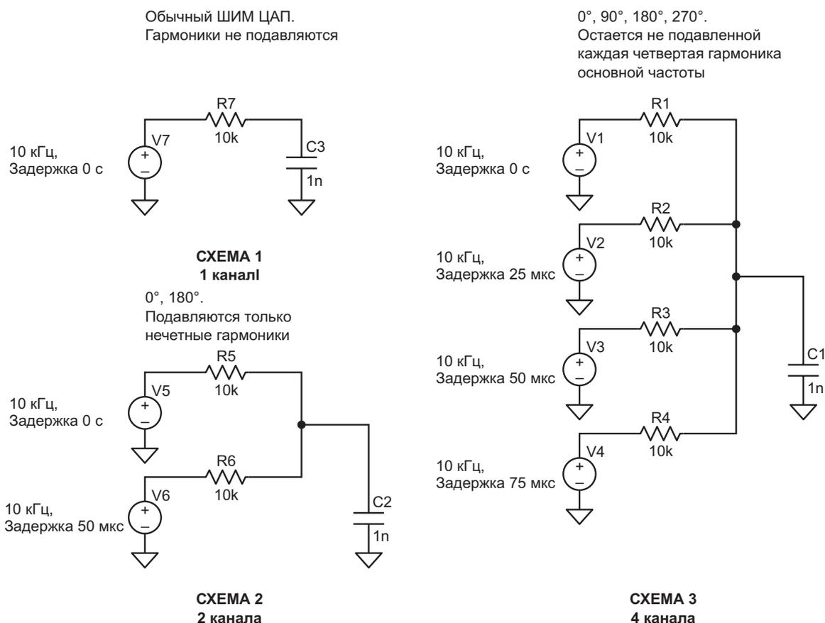
**Рисунок 1.** Схема четырехканального многофазного ШИМ ЦАП наряду с одно- и двухканальной версиями.
