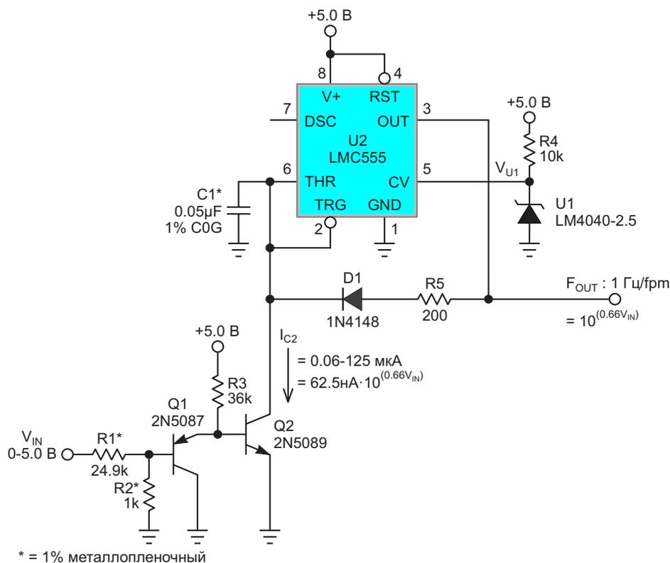
**Рисунок 6.** Антилогарифмически нелинейный преобразователь напряжение-частота.
