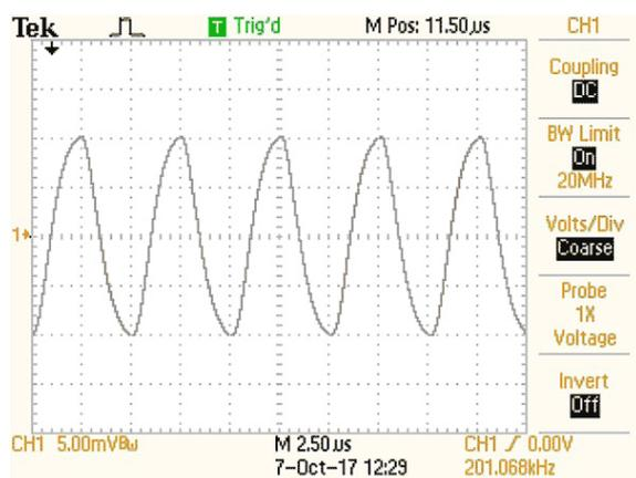
**Рисунок 6.** Прямоугольные импульсы тока  $\pm 10$  мА на выходе источника Хауланда показывают, что 200 кГц фактически выходят за границы его частотной характеристики. Завал фронтов является следствием компенсации, необходимой для устранения выбросов и звона.
