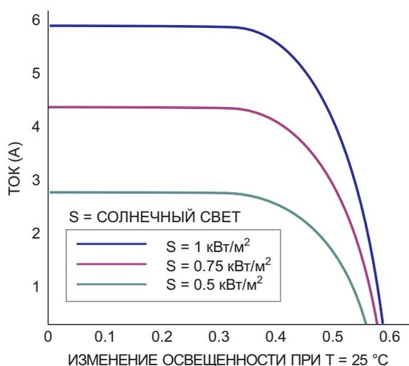
**Рисунок 1.** Выходной ток солнечного элемента падает с уменьшением количества солнечного света.
