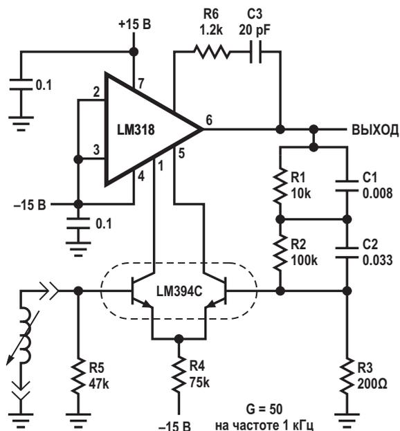
**Рисунок 3.** Для реализации конструкторской идеи National Semiconductor использовала в качестве входного каскада свою суперсогласованную пару LM394.
