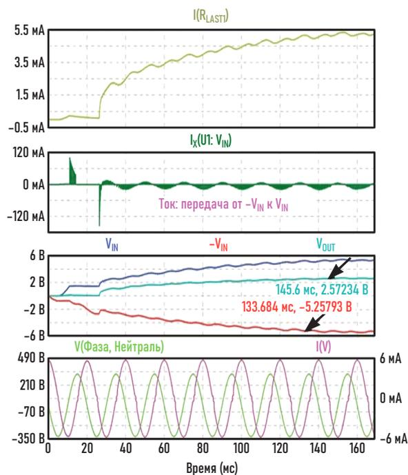
**Рисунок 5.** При запуске и нормальной работе схемы при переменном напряжении 230 В наблюдается изменение полярности тока на выводе  $V_{IN}$  зарядового насоса U1 с периодичностью 5 мс и 15 мс.
