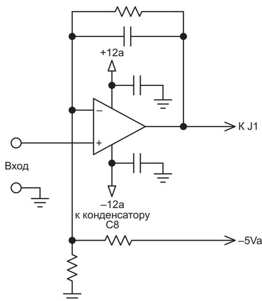
**Рисунок 2.** Для смещения отрицательных (относительно J2) входных напряжений можно использовать обычную схема сдвига уровней, выходное напряжение которой всегда положительное.
