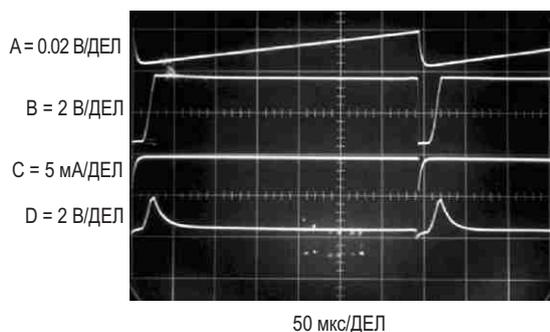
**Рисунок 2.** Осциллограммы сигналов в узлах ПНЧ при напряжении питания 3.3 В. Зарядный насос (осциллограмма С) поддерживает потенциал суммирующей точки (осциллограмма А), обеспечивая высокую линейность и точность.
