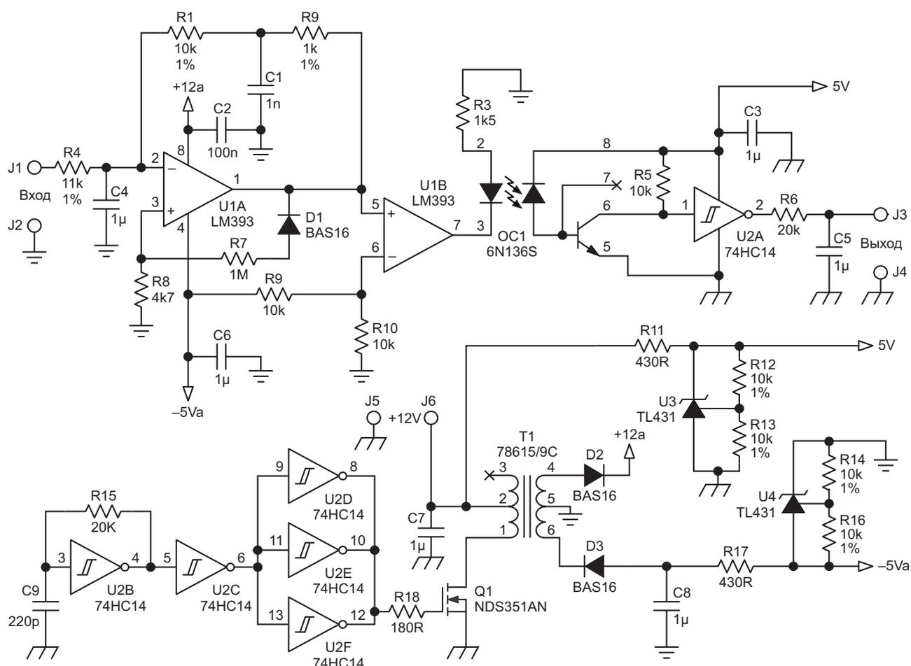
**Рисунок 1.** Плавающий сигма-дельта преобразователь U1 формирует последовательность импульсов, коэффициент заполнения которых зависит от напряжения между контактами J1 и J2. Отфильтрованный постоянный уровень напряжения восстанавливается на выходе J3.
