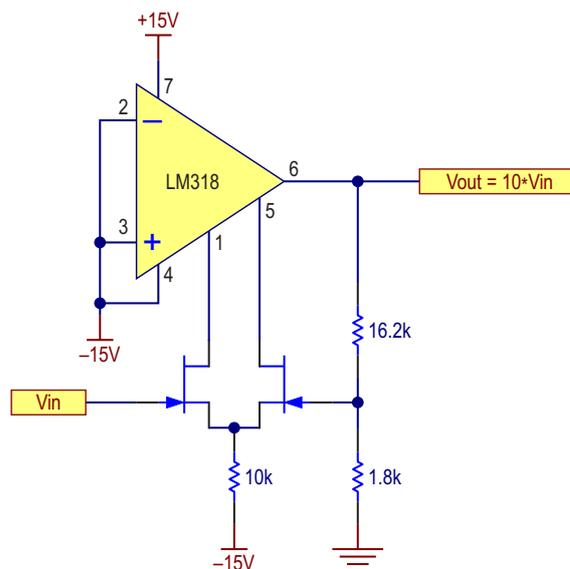
**Рисунок 2.** Моя любимая конструкторская идея, нарисованная по памяти. Умная идея использования всех внутренних выходных каскадов LM318 вместе с выбираемым пользователем входным каскадом оказалась универсальной и привлекательной для меня и других, и в последующие годы она использовалась еще много раз.
