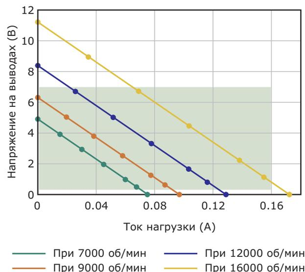
**Рисунок 4.** Зависимость напряжения на выводах от тока нагрузки для высокоэффективного бесщеточного двигателя постоянного тока 16C18.
