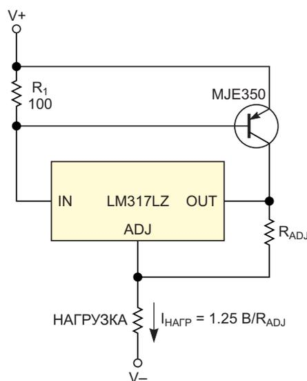
**Рисунок 1.** Этот простой метод позволяет получить источник постоянного тока, не обязательно привязанный к шине питания или земле.
