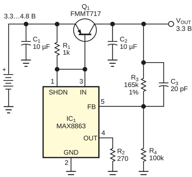
**Рисунок 1.** Нестандартное подключение транзистора к LDO регулятору позволяет снизить падение напряжения со 100 мВ до 10 мВ.
