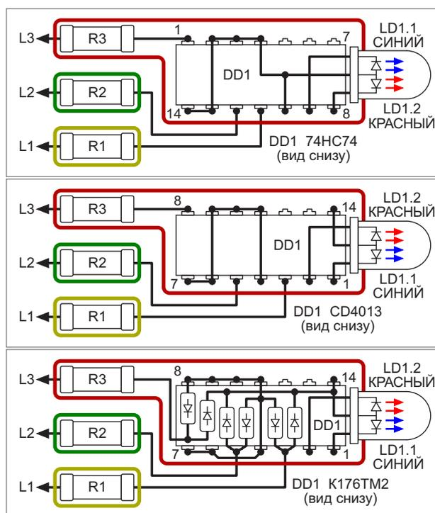
Рисунок 8. Примеры монтажных соединений.
