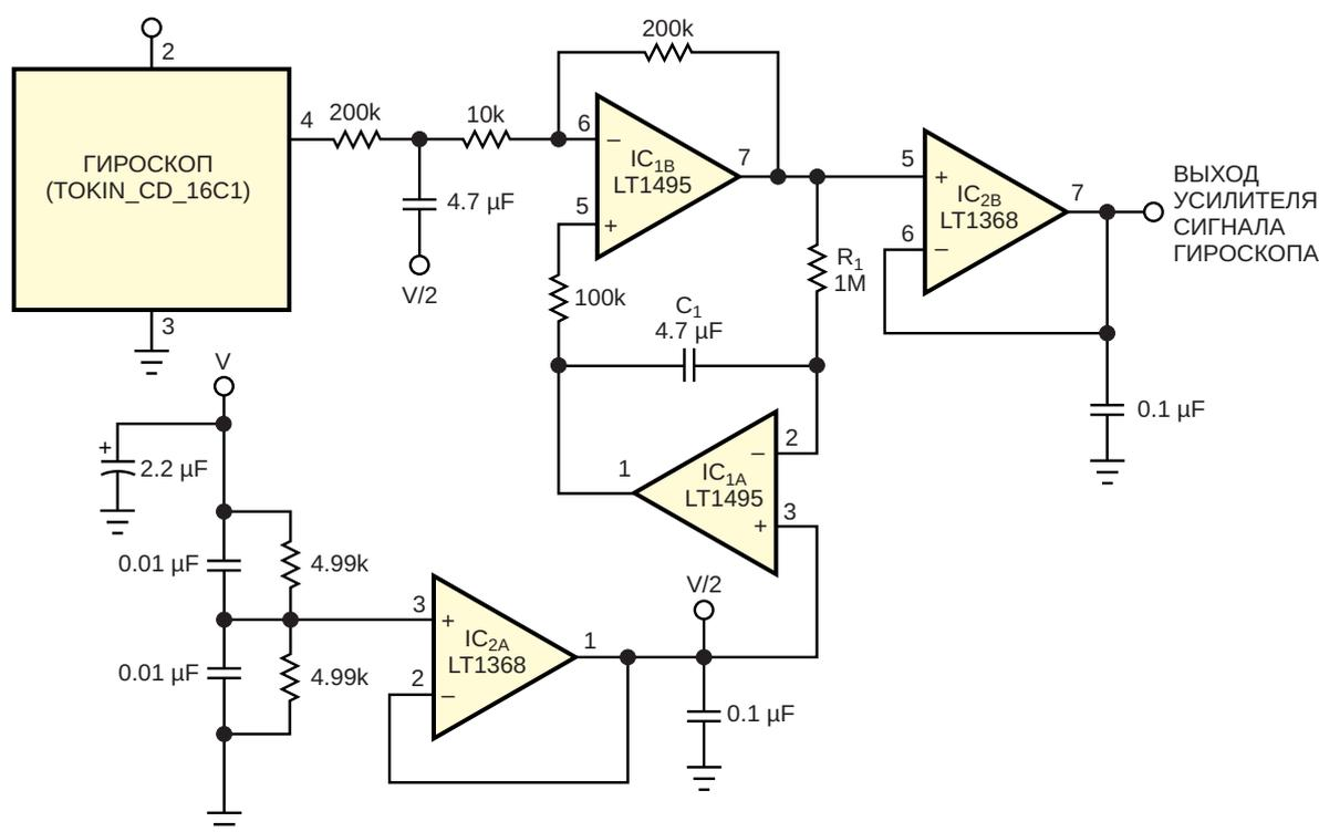
**Рисунок 1.** Сервоусилитель IC<sub>1A</sub> устраняет сдвиг постоянного уровня, обусловленный температурным дрейфом параметров пьезоэлектрического гироскопа.
