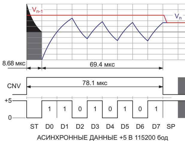
**Рисунок 3.** Временная диаграмма преобразования SDD для 5-вольтовых логических уровней.
