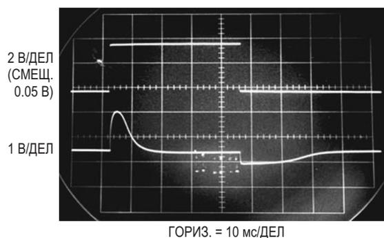
**Рисунок 3.** Отклик (осциллограмма В) на скачок входного напряжения (осциллограмма А) показывает время установления 30 мс в суммирующей точке  $\Sigma$ . Конденсатор 1 мкФ между входом и выходом усилителя А1 формирует отклик, стабилизируя контур обратной связи. «Обрезанный» отклик на отрицательный скачок входного напряжения обусловлен ограничением суммирующего узла.
