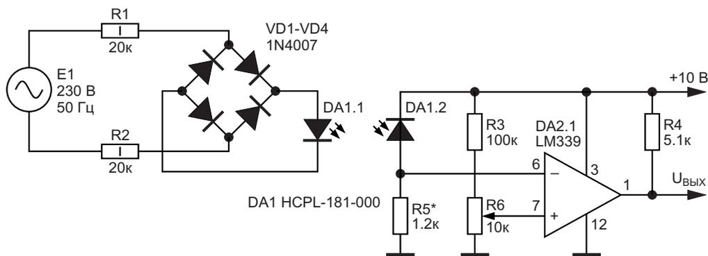
**Рисунок 2.** Индикатор перехода сетевого напряжения через ноль с использованием оптрона и компаратора.
