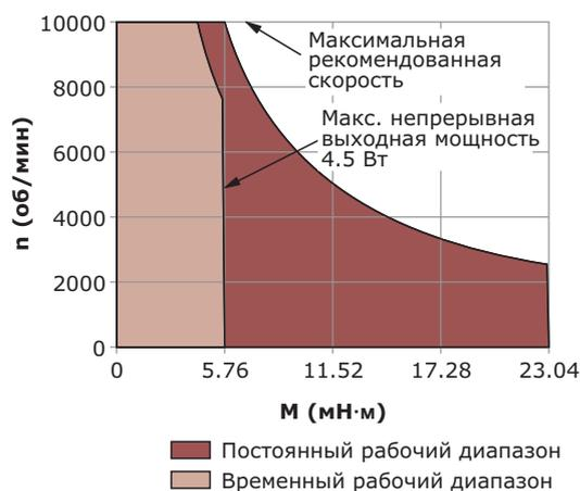
**Рисунок 3.** Рабочий диапазон двигателя Portescap 17 DST. (Зависимость скорости от вращающего момента).
