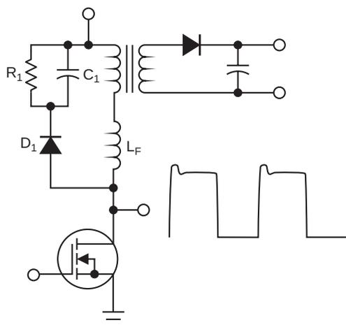
**Рисунок 2.** В этой схеме медленный диод защищает ключевой транзистор от разрушительных переходных напряжений.
