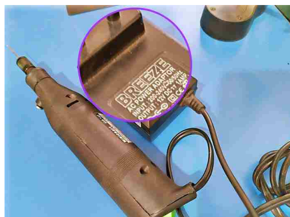
Рисунок 5. Старая ручная электродрель для сверления печатных плат.
