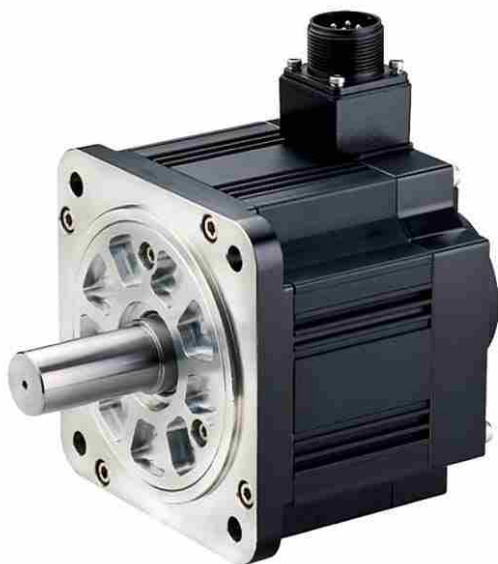
Рисунок 3. Серводвигатели, используемые в замкнутой петле обратной связи, обеспечивают более высокие значения точности, скорости и ускорения, чем шаговые двигатели.
