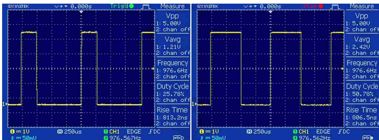
Рисунок 2. Осциллограммы сигналов ШИМ.
