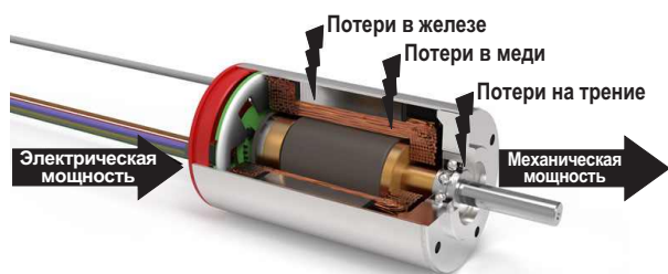
Рисунок 1. На этом разрезе BLDC-двигателя Portescap показаны места возникновения различных потерь и путь перехода от электрической энергии к механической.
