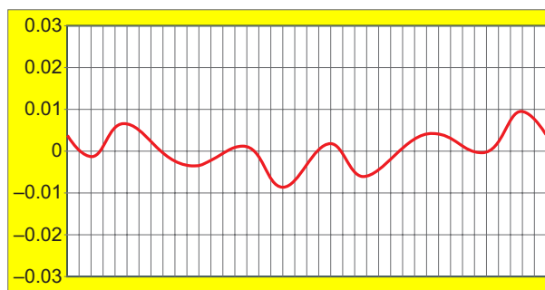
Рисунок 3. Усечение треугольника до трапеции на уровне \pm 67\% перед интегрированием снижает пиковую ошибку синусоиды, в основном от 5-й гармоники, до менее чем \pm 1\% .
