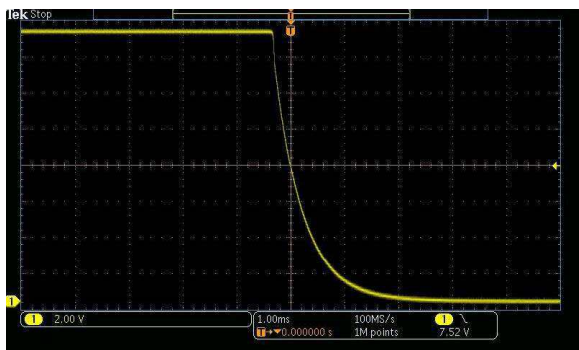
Рисунок 4. Медленное выключение может быть приемлемым при небольших нагрузках.
