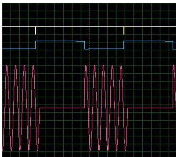
Рисунок 3. Смоделированные формы напряжений на выходе таймера U3 (желтый), на выходе таймера U4 (синий) и на нагревателе (розовый). При другом положении потенциометра RV1 на нагрузку подаются пять полных периодов, и пять полных периодов пропускаются.
