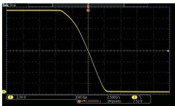
Рисунок 6. Модификация схемы обеспечивает более быстрый переход от включенного состояния к выключенному.
