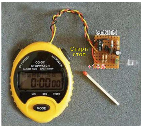
**Рисунок 1.** Схему можно собирать на небольшой макетной плате, которая подключается к секундомеру CG-501.
