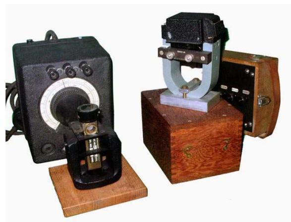
**Рисунок 1.** Электромагнитный регистратор измеряет изменения электрического тока, пропуская его через магнитную катушку.
