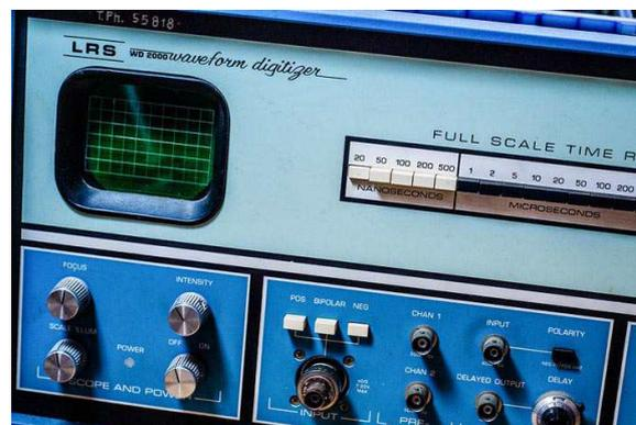
**Рисунок 3.** Дискретизатор сигналов WD 2000 объединил в одном корпусе АЦП реального времени, память и дисплей.
