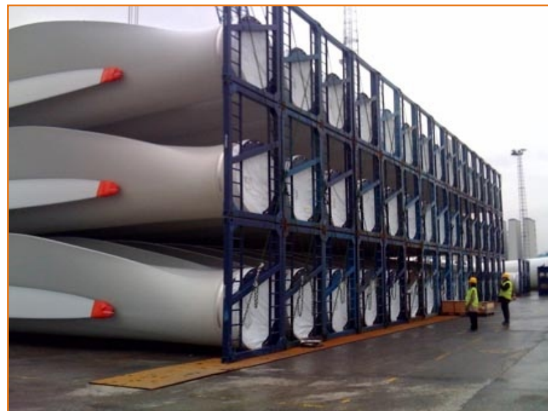
Транспортные контейнеры для лопастей турбин, изготавливаемых фирмой Vestas
