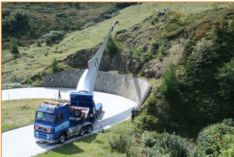
На горной дороге в швейцарских Альпах поворот радиусом всего 15 м трейлер фирмы Scheuerle преодолел за 3 минуты
