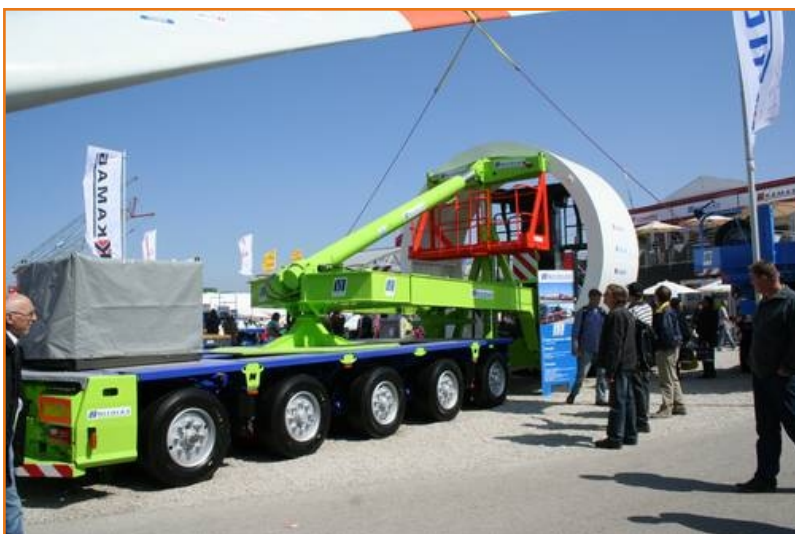
Новый адаптер фирмы Nicolas для транспортировки мачт ветрогенераторов
