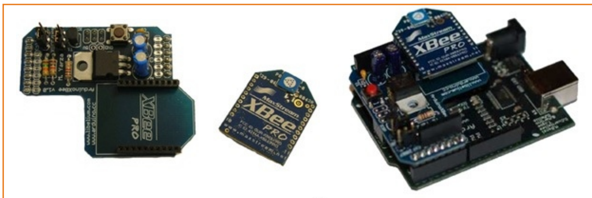
Рисунок 4. Платы расширения Libelium XBee Shield позволяют непосредственно подключить радио модули MaxStream к популярным платам Arduino.
