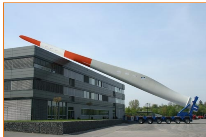
Специальный трейлер фирмы Scheuerle обхватывает основание лопасти и, используя гидравлический привод, может поднимать ее на 23°
