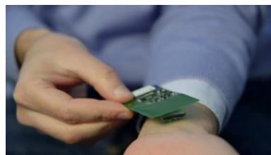
Рисунок 3. Для питания имплантата и передачи данных от него используется специальный беспроводной модуль (Фото: EPFL).
