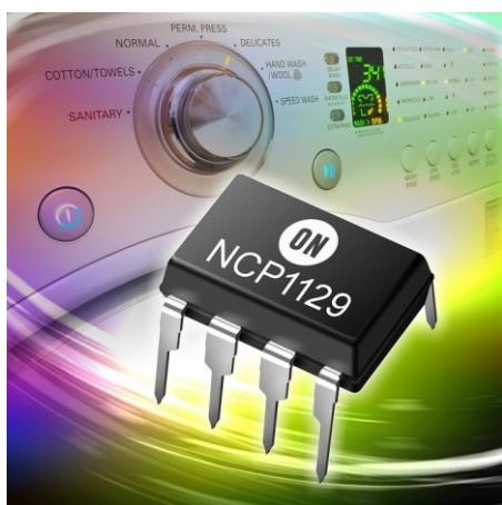
Высокая степень интеграции микросхем сводит к минимуму количество необходимых внешних компонентов, позволяя использовать их в бытовых электроприборах, проигрывателях DVD и телевизионных приставках. NCP1129, NCP1126 и NCP1124 могут отдавать в нагрузку 25 Вт, 15 Вт и 12 Вт, соответственно. Частота тактовых генераторов каждой микросхемы постоянно флукутирует вокруг значений 65 кГц или 100 кГц, что значительно снижает уровень электромагнитных излучений.
