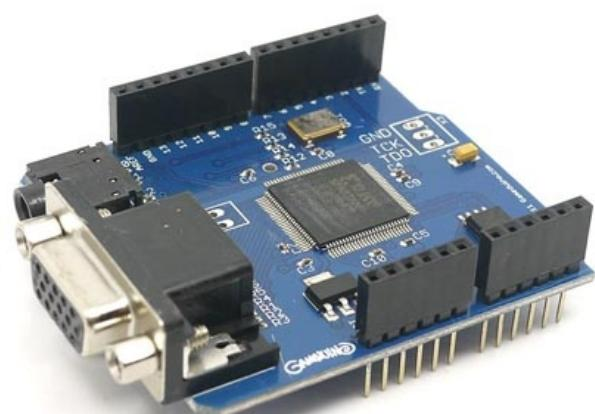
*Рисунок 2. Первая версия Gameduino выполнена на ПЛИС и рассчитана на подключение к стандартному VGA монитору.*
