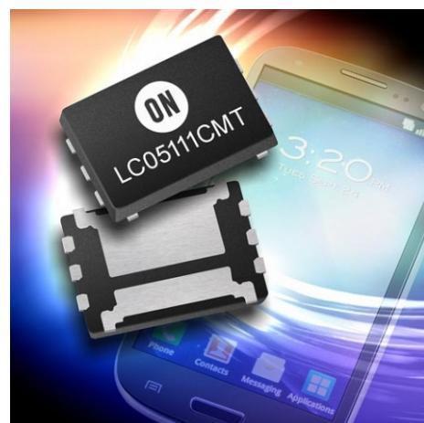
заряда за счет увеличения зарядного тока. Устройство содержит высокоточные схемы детекторов и задержек включения, защищающие аккумулятор от перезаряда и глубокого разряда, а также от превышения разрядного и зарядного токов. Благодаря высокому уровню интеграции сокращается количество необходимых внешних компонентов, и, соответственно, уменьшается площадь, занимаемая схемой на печатной плате.
