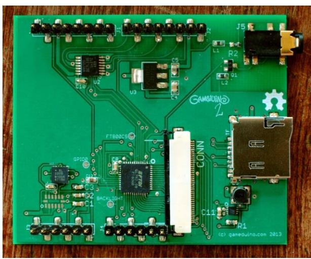
**Рисунок 4.** Выполненная на графическом контроллере FT800 плата Gameduino 2 имеет ЖК дисплей, сенсорный экран и поддерживает набор команд в стиле OpenGL.
