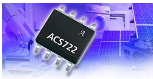
мой после корпусирования прибора. При возрастании тока, протекающего через основной медный проводящий канал (от выводов 1 и 2 к выводам 3 и 4), выходное напряжение имеет положительный наклон. Типовое внутреннее сопротивление канала составляет 0.6 мОм, обеспечивая минимальные потери мощности.
