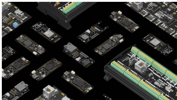
Portenta – это семейство промышленных систем-на-модуле от Arduino.
