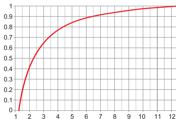
Рисунок 3. График, обратный Рисунку 2, или коэффициент заполнения ШИМ D , необходимый для получения любого заданного V_{OUT} , где D = (1.111 - 1.389/V_{OUT}) .
