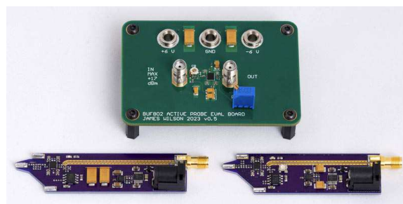
Рисунок 3. Более поздняя оценочная плата с версиями В и С устройства в форм-факторе щупа.
