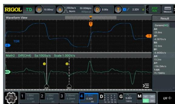
**Рисунок 9.** Использование высокоимпедансного входа осциллографа в рефлектометрическом тесте 135-сантиметрового отрезка провода диаметром 0.5 мм. Функция математической обработки отображает производную кривой, позволяя видеть результаты более ясно.
