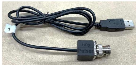
**Рисунок 2.** Основанный на схеме на Рисунке 1 прототип *Tiny Pulser* с корпусом, напечатанным на 3D-принтере, имеет размер примерно с кубик сахара.
