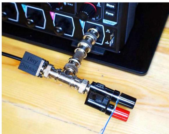
**Рисунок 8.** Рефлектометрическая установка, использующая Tiny Pulser с тройниковым переходником BNC для подключения схемы (например, через коаксиальный кабель, витую пару и т. д.).
