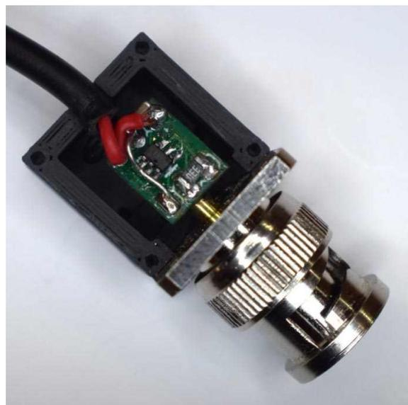
**Рисунок 3.** Печатная плата *Tiny Pulser* в корпусе, где видны разъем BNC, микросхема и пассивные компоненты, использованные в схеме на Рисунке 1.
