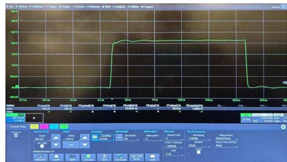
**Рисунок 7.** Фотография экрана профессионального осциллографа (2.5 ГГц, 20 Гвыб/с) при измерении времени нарастания и спада Tiny Pulser.
