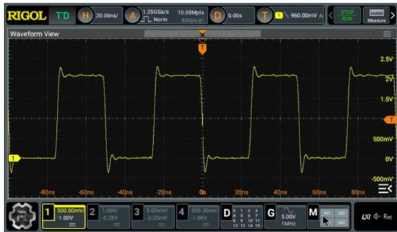
**Рисунок 5.** Последовательность импульсов Tiny Pulser частотой 20 при использовании 50-омного входа осциллографа.
