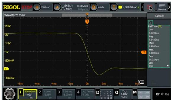
**Рисунок 6.** Измерение времени спада (1.34 нс) схемы Tiny Pulser, выполненное на 50-омном входе осциллографа.
