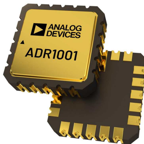
Рисунок 3. Герметичный 20-выводной керамический корпус LCC.
