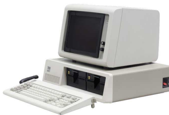
Рисунок 2. Модель IBM 5150 оснащалась процессором Intel 8088, оперативной памятью объемом до 256 КБ и приводами гибких дисков 5.25" или кассет для хранения данных.
