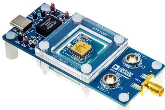
Рисунок 2. Сопутствующая оценочная плата ADR1001E-EBZ обеспечивает вывод напряжения 5 В через разъем SMA, а также через разъемы типа «банан».
