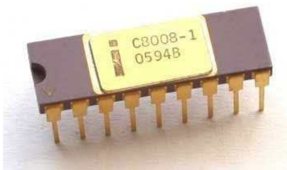
Рисунок 1. Вариант процессора C8008-1 компании Intel, содержащий 3500 транзисторов в корпусе с двухрядным расположением 18 выводов и работавший на максимальной частоте 800 кГц.
