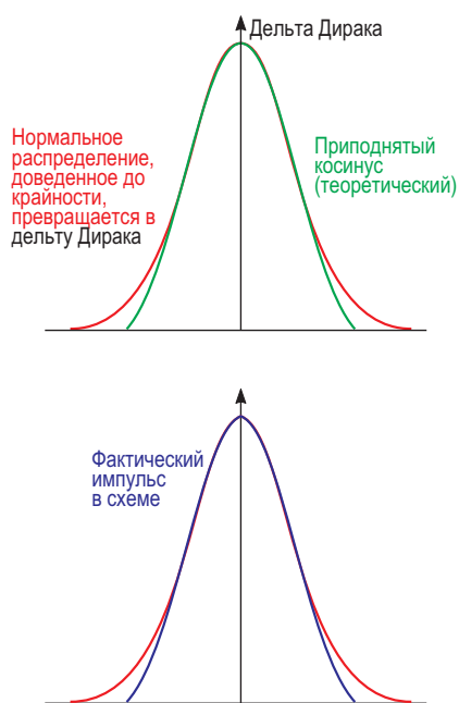
Рисунок 3. Сравнение идеальной кривой нормального распределения и приподнятого косинуса – выходного сигнала схемы на Рисунке 1.
