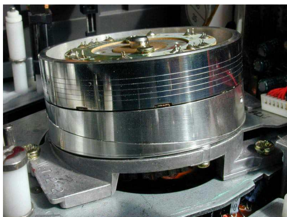
Рисунок 1. Спиральное сканирование – это метод записи высокочастотных сигналов на магнитную ленту с использованием вращающегося барабана, оснащенного магнитными головками.
