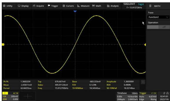
Рисунок 2. Чистая синусоида 16 кГц на выходе генератора Пельца.
