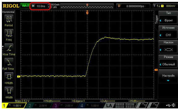
Рисунок 5. Фронт выходного сигнала микросхемы D1 при отсутствии резистора R3.
