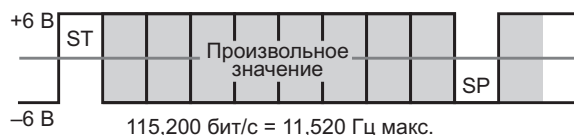
Рисунок 2. Каждому импульсу ПНЧ соответствует правильно отформатированный, но пустой символ RS-232.
