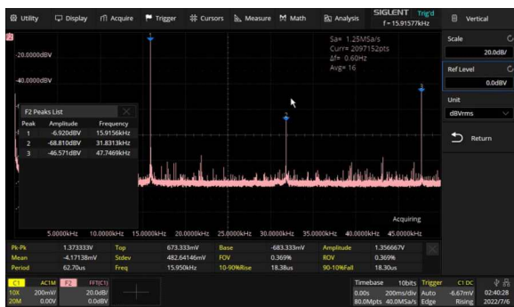
Рисунок 3. Спектр синусиды, показывающий основную, вторую и третью гармоники.
