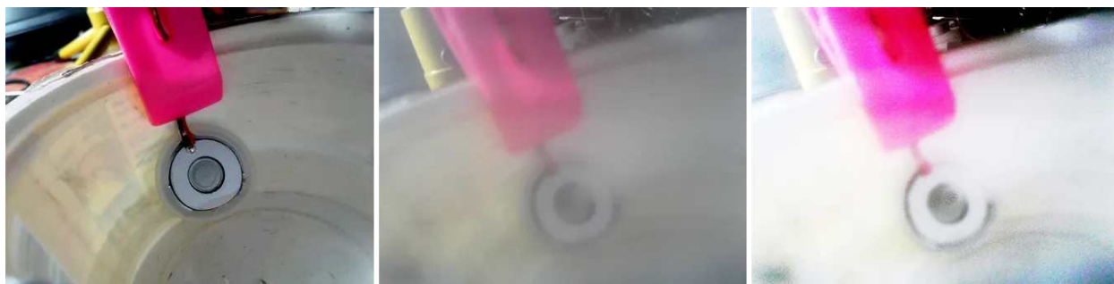
Рисунок 5. Тестирование прототипа ультра-звукового туманообразователя.
