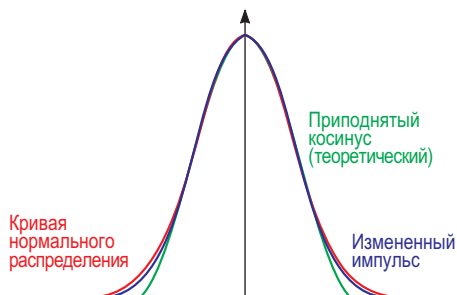
Рисунок 7. Улучшенная форма импульса, полученная за счет добавлений, показанных на Рисунке 6.
