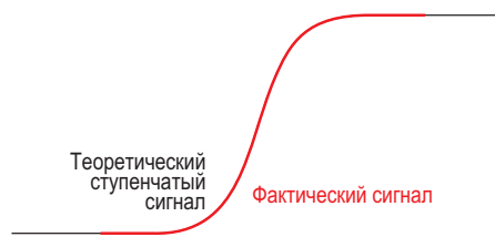
Рисунок 6. Сравнение целевой кривой с частью осциллограммы D на Рисунке 5.
