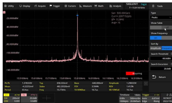
Рисунок 4. Синусоида частотой около 16 кГц в увеличенном масштабе.
