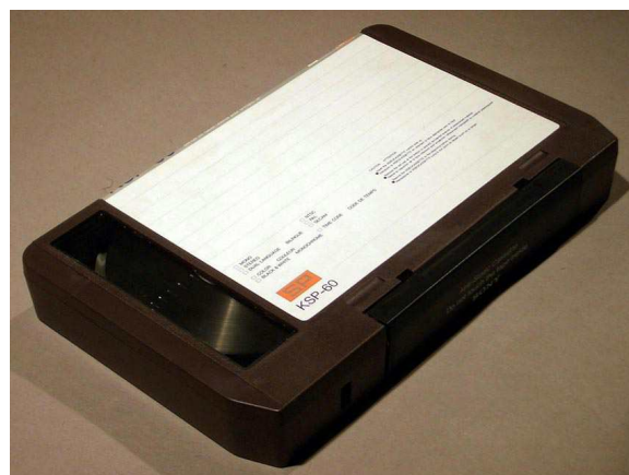
Рисунок 2. Картриджи U-matic были похожи на кассеты VHS, только они были больше, использовали ленту шириной \frac{3}{4} дюйма и имели максимальное время записи 80 минут.
