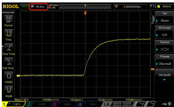
Рисунок 6. Фронт выходного сигнала микросхемы D1 с установленным резистором R3 (270 Ом).
