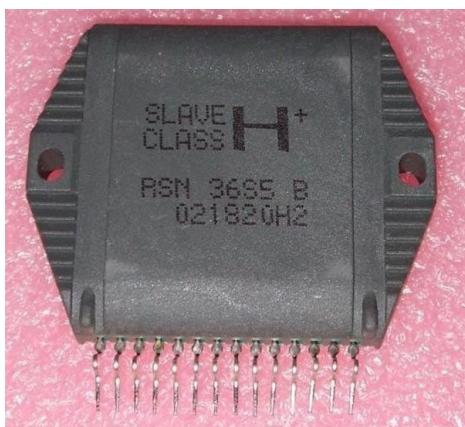
Рисунок 9. Гибридная микросхема RSN36S5A.
