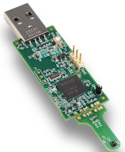
Оценочная плата цифрового датчика температуры TMP117 (TMP117EVM).
