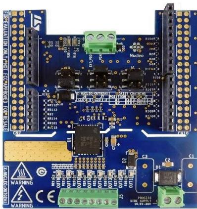
Промышленная плата расширителя цифровых выходов для STM32 Nucleo на основе микросхемы ISO8200AQ.
